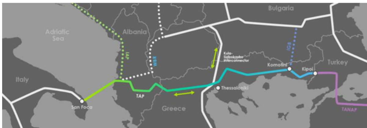
Slika 7-2. Ruta Trans-Jadranskog plinovoda (TAP, 2020b)
