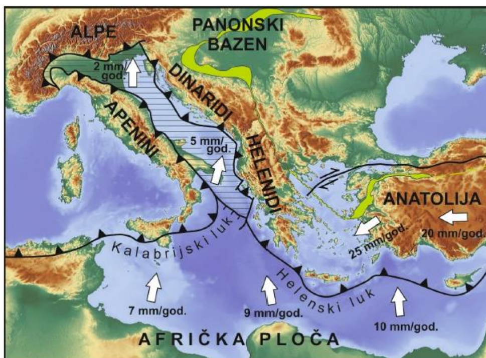
Slika 4.1 Geodinamska skica područja istočnog Sredozemlja i brzine konvergentnih kretanja Afričke ploče, Anatolijskog bloka i Jadranske mikroploče prema Euroazijskoj ploči (Dasović et al., 2020).
