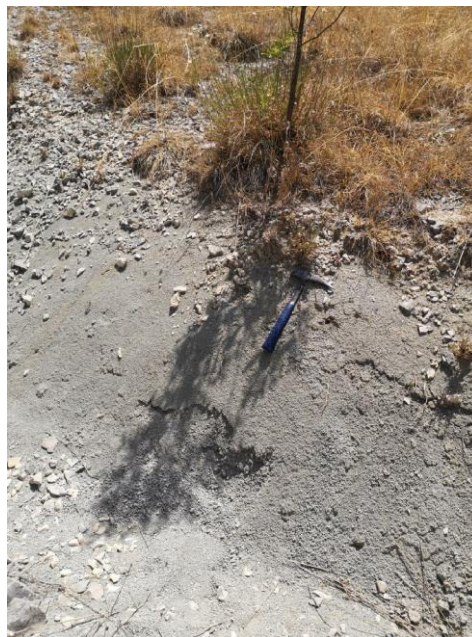
Slika 5-11. Površinski iskop u kojem se pojavljuje lapor s višim udjelom gline. Točka T65.
