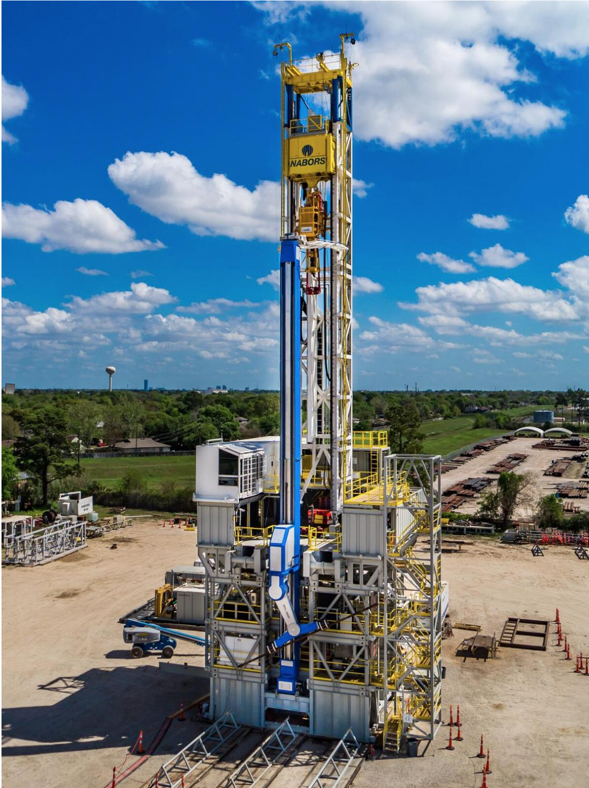
Slika 5-1. Potpuno robotizirano bušaće postrojenje koje je izradila kompanija Canrig Robotics u službi servisne kompanije Nabors Industries (Energid, 2021)
