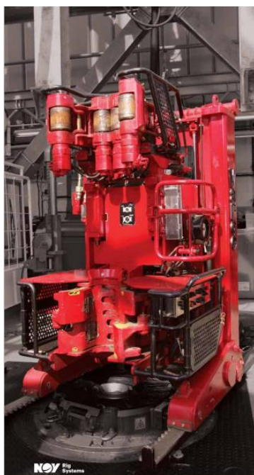
Slika 4-4. Automatizirani hidraulički sustav za navrtanje/odvrtnje cijevnih alatki kompanije NOV, model AR-3200 (NOV, 2013a)
