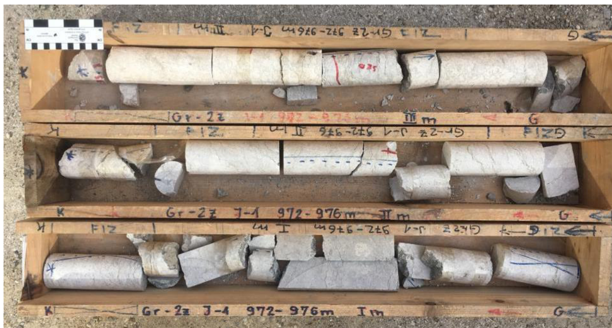
Slika 9-1 Jezgre iz bušotina A-1Z (805 – 811 m) i A-2Z (972 – 976 m)
