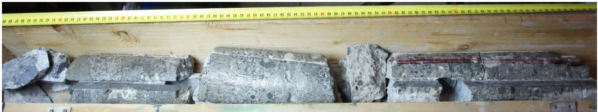
Slika 5.34: Kal-19 klastima potporni konglomerat iz J-1
