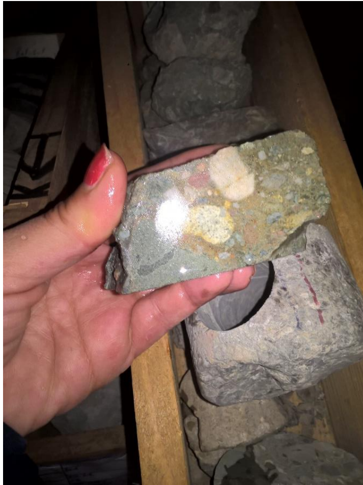
Slika 5.39: Kal-1S, erozijski kontakt pješčenjaka i konglomerata u fragmentu iz J-4
