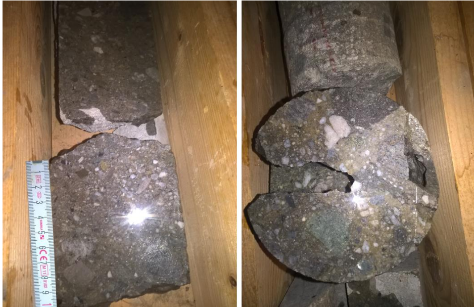
Slika 5.46: StG-6 J-1, fragmenti polimiktnog, klastima potpornog konglomerata iz 6. i 7.m
