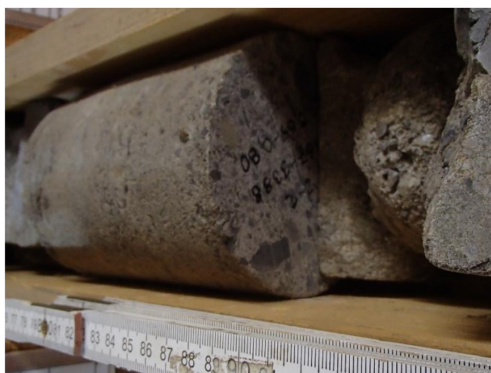
Slika 5.44: Kal-7 J-1, fragmenti polimiktnog konglomerata
