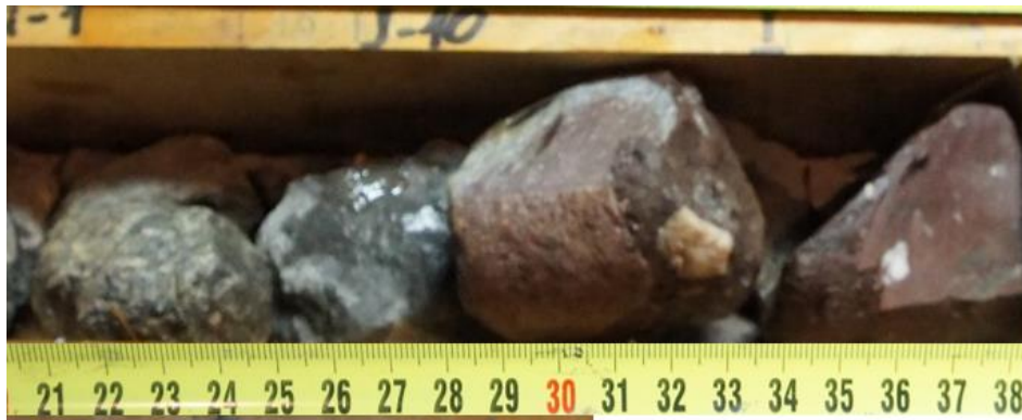
Slika 5.18: Di-1 ostatak J-10, matriksom potporni konglomerat s hematitiziranim vezivom
