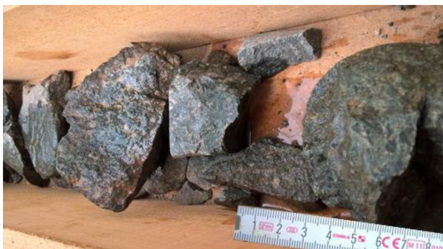
Slika 5.67: DB-1 fragmenti kristalolitoklastičnog tufa iz J-10
