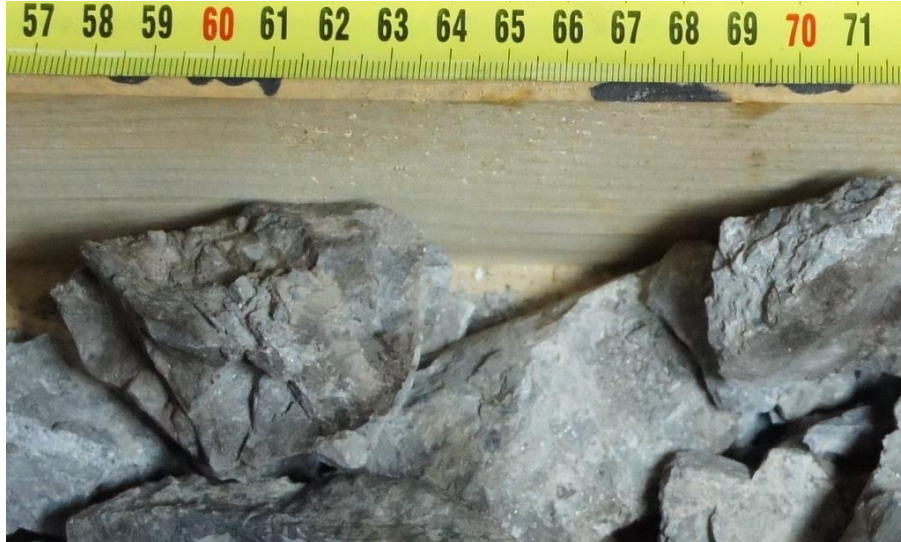
Slika 5.52: Mlj-1, fragmenti klastima potporne breče iz J-12
