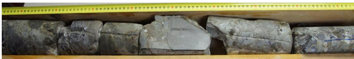
Slika 5.35: Kal-16 J-2, klastima potporni konglomerat iz 4.m
