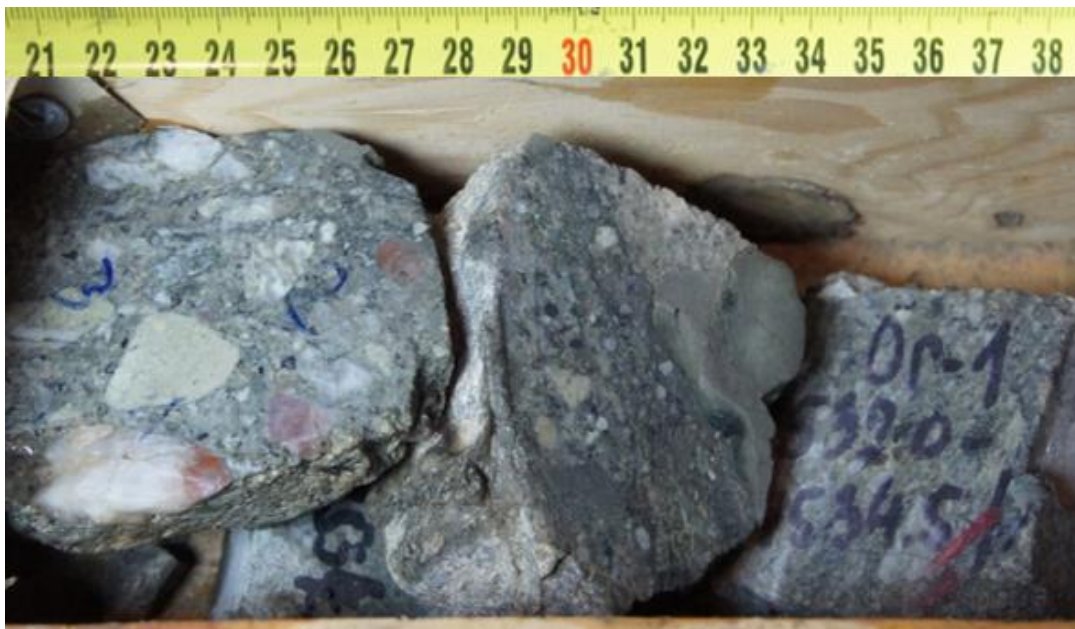
Slika 5.57: Or-1 ostatak fragmenata klastima potpornog konglomerata iz J-11
