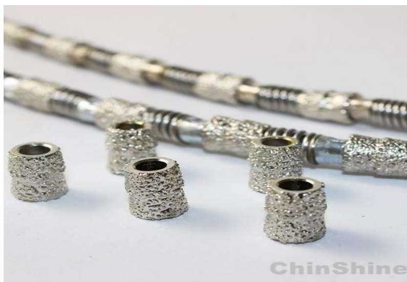
Slika 2-2: Dijamantna žica (ChinShine dijamantni alati, 2019.)
