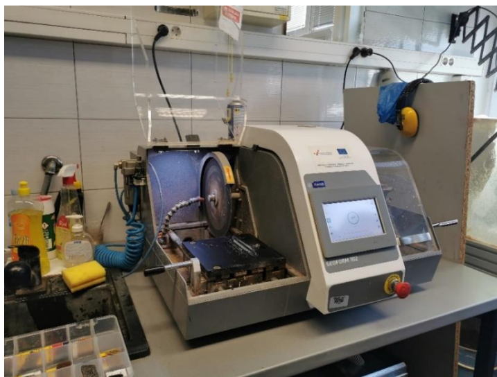
Slika 5-4. Uređaj za piljenje/dimenzioniranje Kemet Geoform 102.
