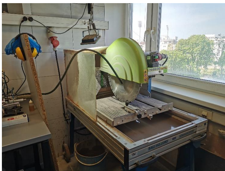
Slika 5-3. Uređaj za piljenje (pila za piljenje stijena SSB tip alfa).
