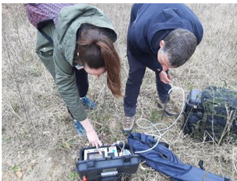
Slika 5-7. Primjer mjerenja koncentracije radona u tlu
