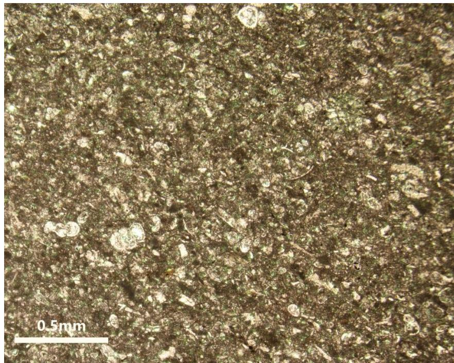
**Slika 5-11.** Mikropetrografska građa homogenog biokalkluita (uzorak TG13) s detritusom siltnih dimenzija (svijetlo).
