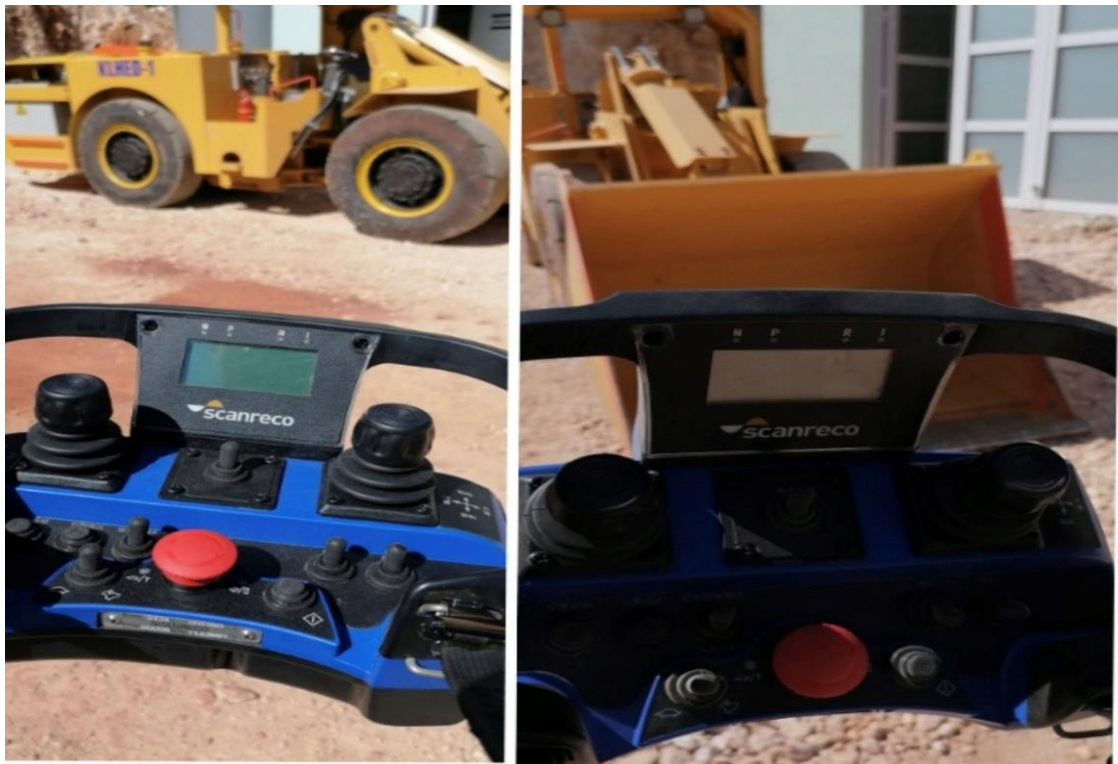
Slika 5-3. Daljinske komande jamskog utovarivača KHLED-1
