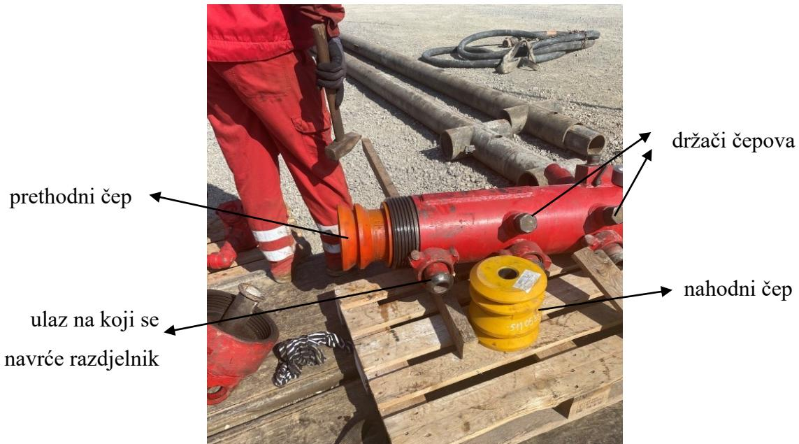
**Slika 2-4.** Postavljanje cementnih čepova u glavu za cementaciju
