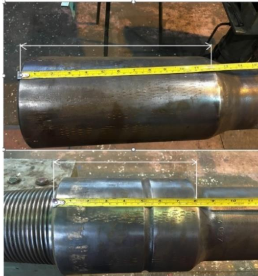
Slika 4-16. Mjerenje dijela za obuhvat kliještima na ženskom i muškom dijelu spojnice (CROSCO, 2019)
