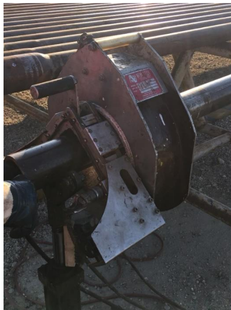
Slika 3-18. Pregled tijela bušaće šipke elektromagnetskom metodom (CROSCO, 2019)
