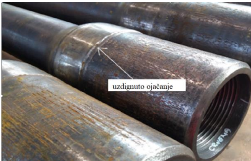
Slika 4-18. Uzdignuće ojačanja (CROSCO, 2019)
