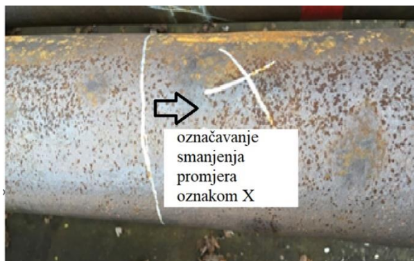
Slika 3-9. Označavanje područja najvećeg smanjenja promjera oznakom X (CROSCO, 2019)
