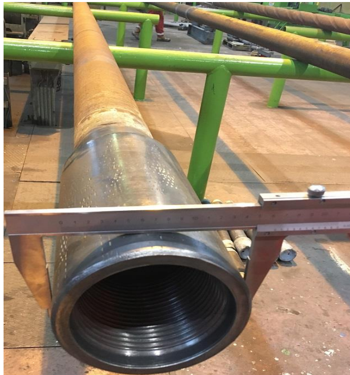
Slika 4-3. Provjera vanjskog promjera ženske spojnice (Crosco, 2008)
