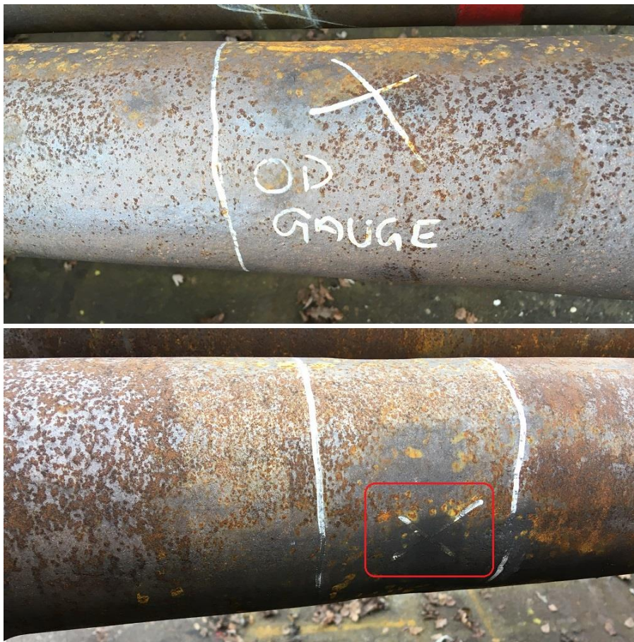
Slika 3-6. Označavanje dijela maksimalnog odstupanja vanjskog promjera (Crosco, 2008)
