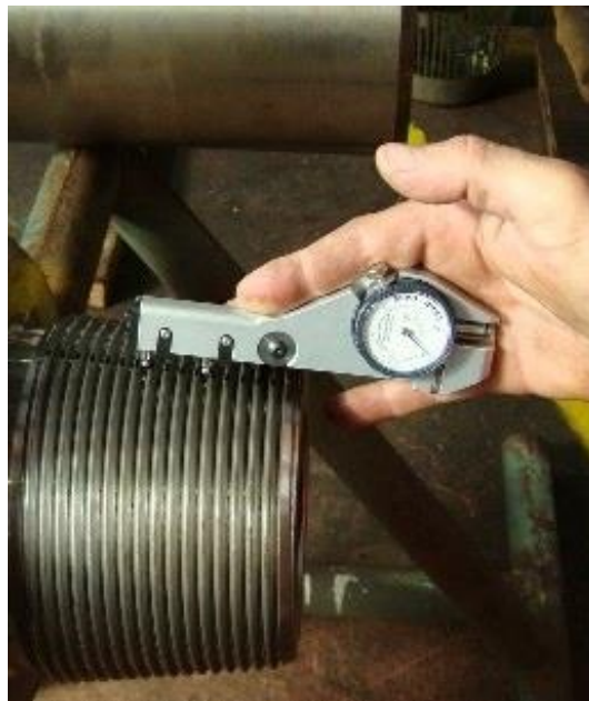
Slika 4-4. Provjera produljenja muškog navoja mjerilom uspona (Crosco, 2008)
