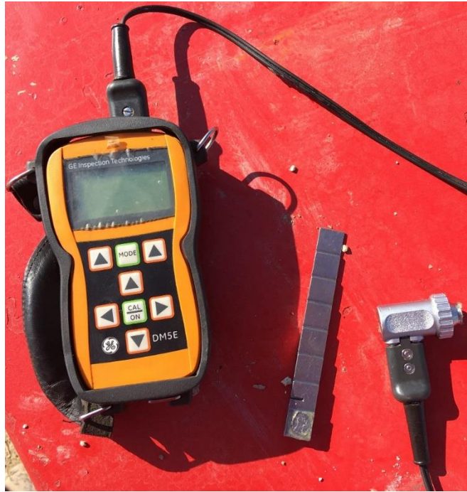
Slika 3-7. Ultrazvučni mjerac debljine stjenke (Crosco, 2008)
