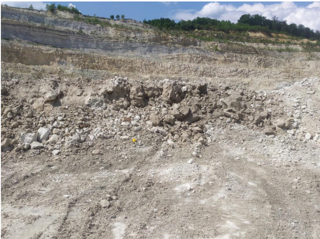
Slika 8-6 Granulacija minskog polja Sivo-bijeli Ø60
