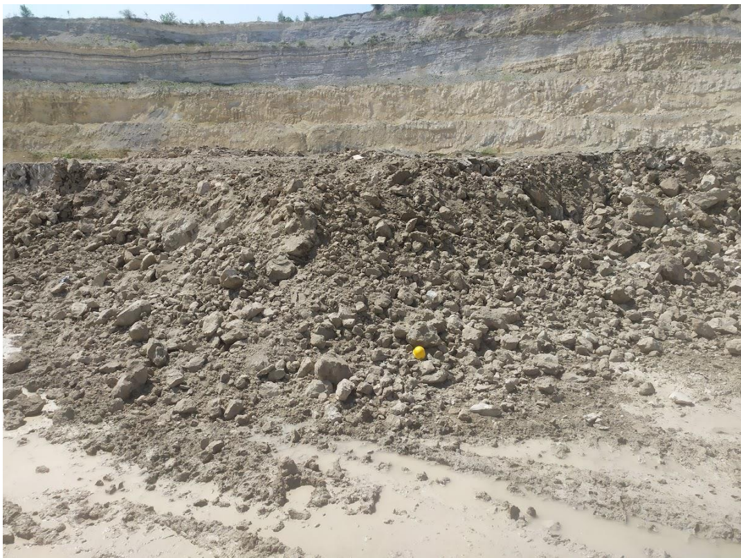
Slika 8-4 Granulacija minskog polja Sivi Ø70
