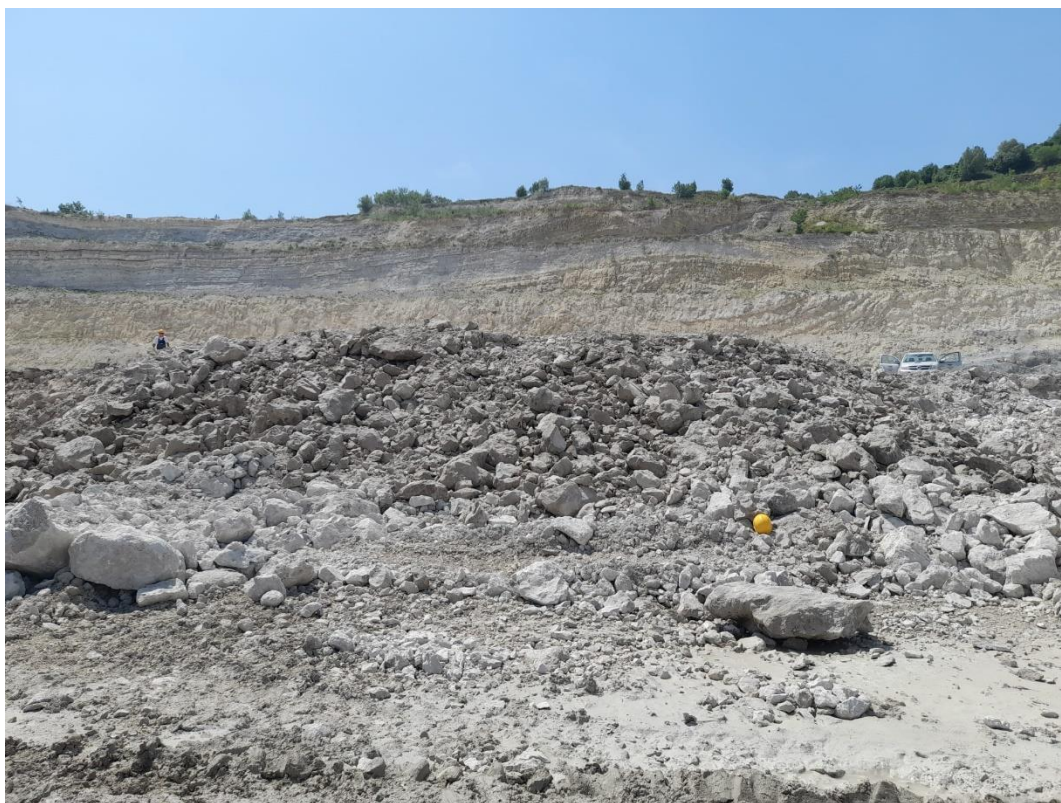
Slika 8-2 Granulacija minskog polja Sivi Ø60
