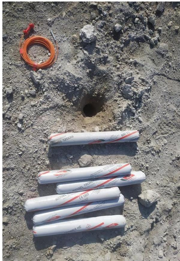
Slika 6-1 Neelektrični detonator i patronе za pojedinu bušotinу
