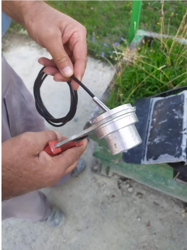
Slika 6-6 Spajanje rudarske kapice br. 8 na sporogoreći štapin
