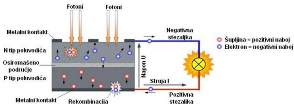
**Slika 1-1.** Shema fotoelektričnog efekta (Novak Mavar, 2021)
