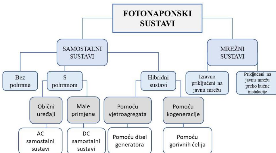
**Slika 1-2.** Podjela fotonaponskih sustava (Kvaternik, 2019)
