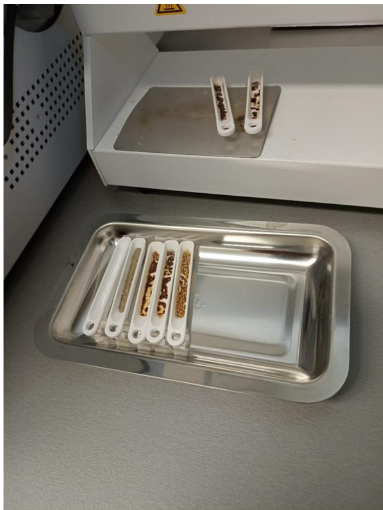
Slika 3.4. Uzorci nakon spaljivanja u komori
