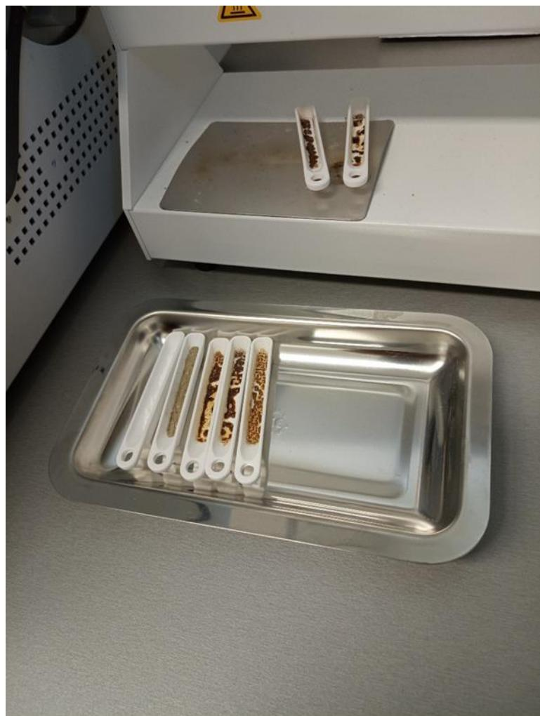
**Slika 3.4.** Uzorci nakon spaljivanja u komori
