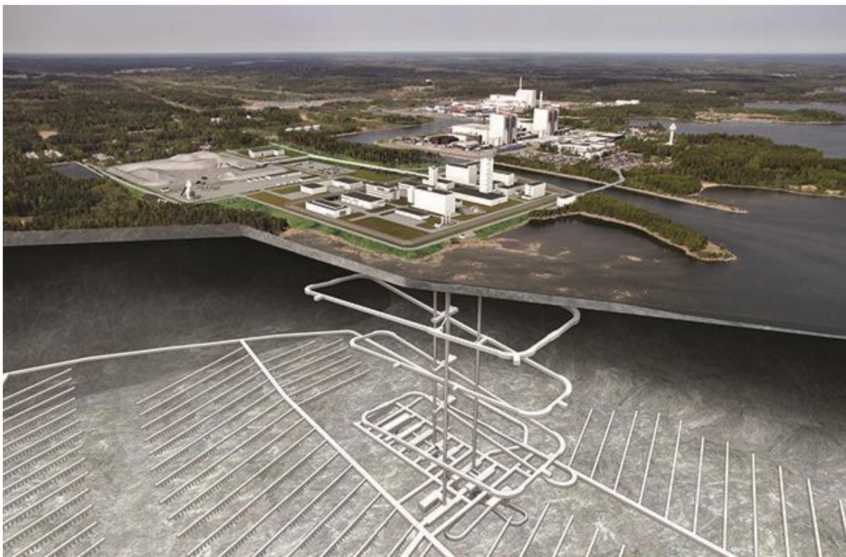
Slika 2-6. Shema odlagališta nuklearnog otpada u blizini nuklearne elektrane Forsmark u Švedskoj (Patrakka, 2010)
