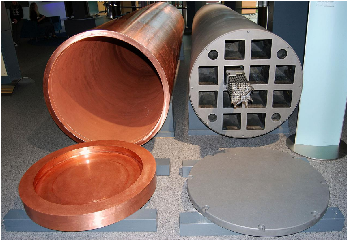
Slika 2-5. Spremnik namijenjen za odlaganje nuklearnog otpada u Švedskoj i Finskoj ( https://en.m.wikipedia.org , 2022)
