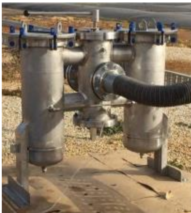
Slika 5-11. Mikro jedinica za obradu kiselog plina NASS tehnologijom (Whittaker, 2018)
