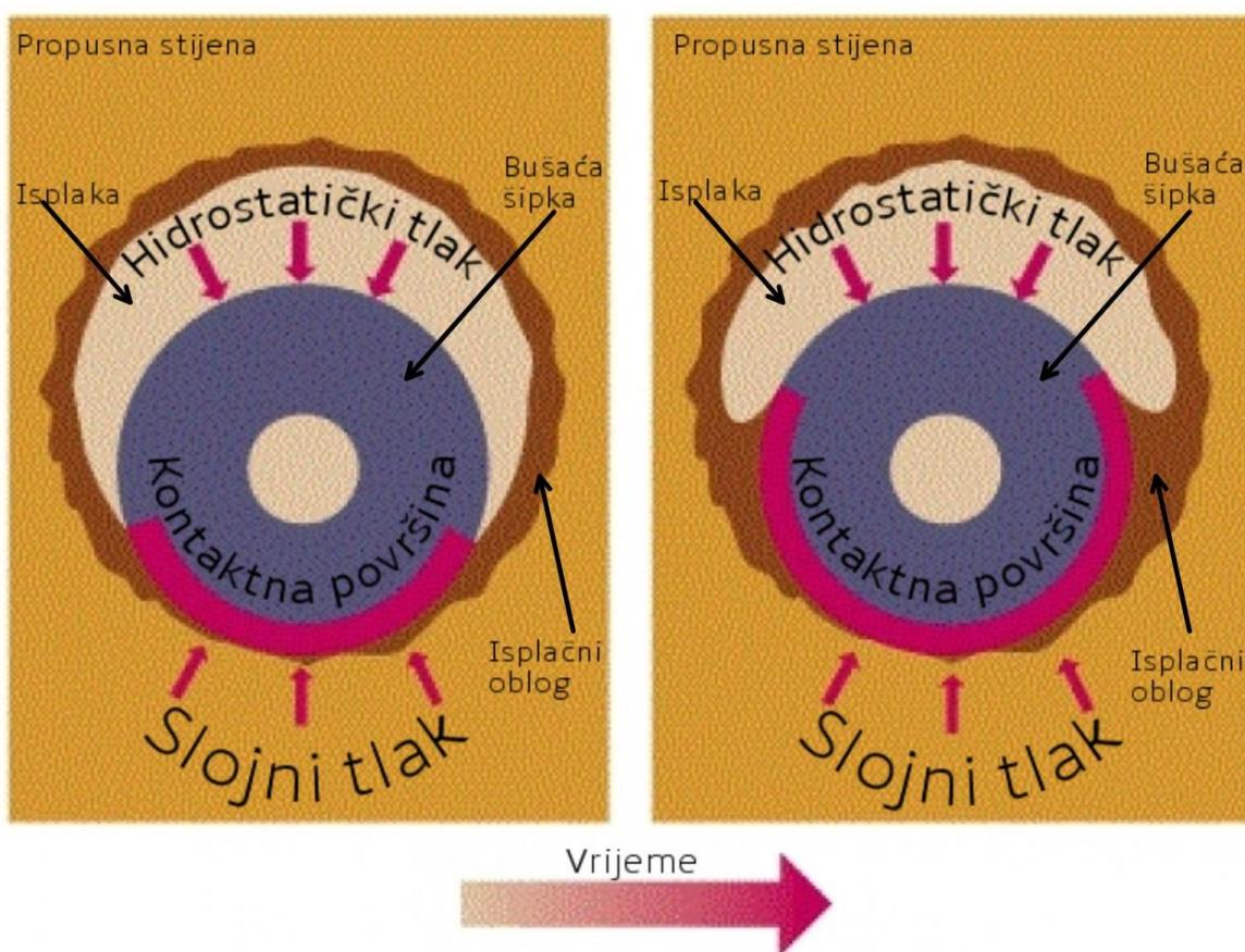
Slika 3-5. Shematski prikaz diferencijalnog prihvata (<https://glossary.oilfield.slb.com>)
