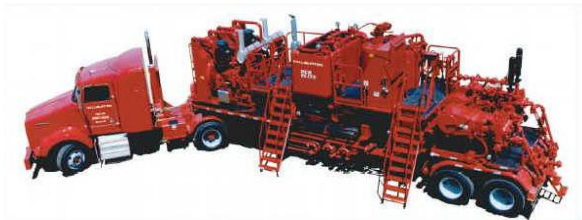
Slika 4-19. Cementacijski agregat (Gaurina-Međimurec, 2020)
