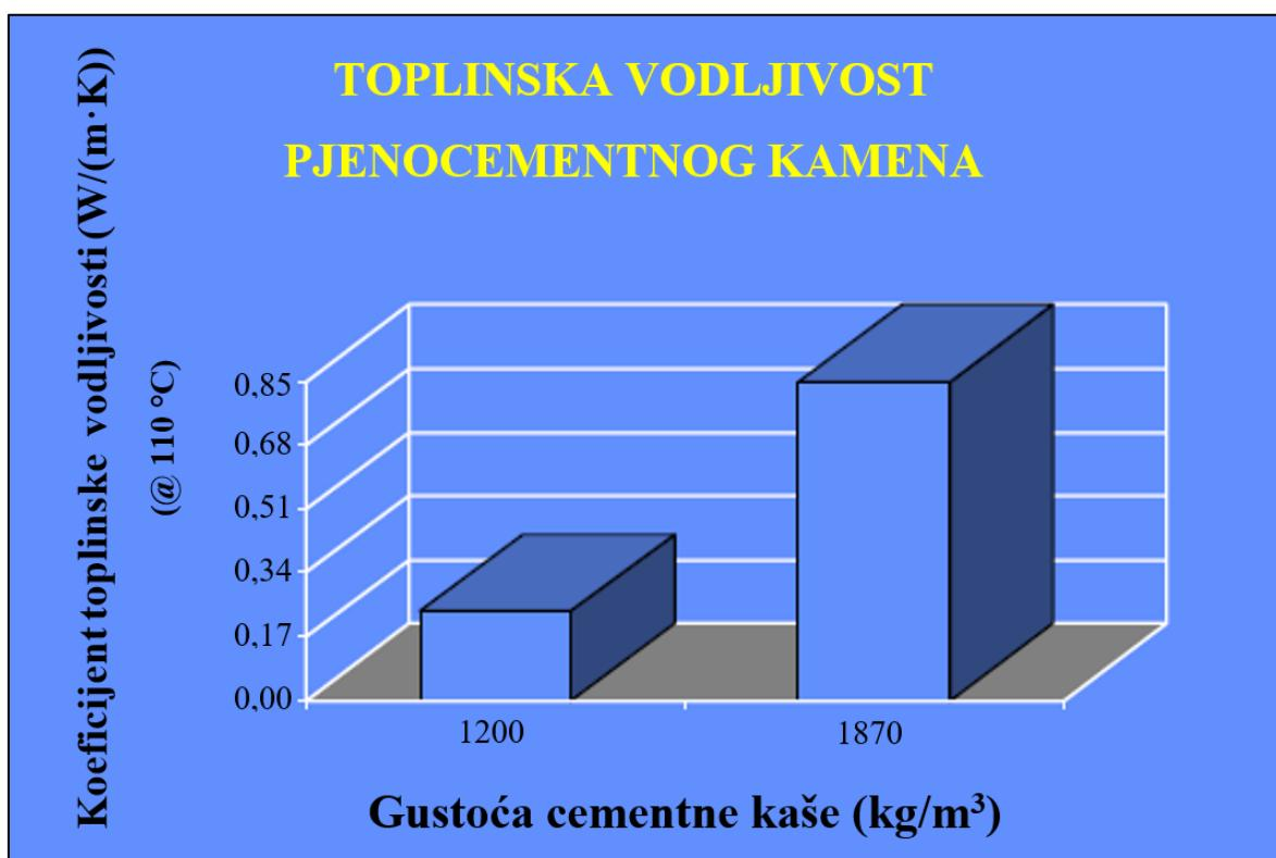
Slika 4-26. Toplinska vodljivost cementnog kamena (Niggemann et al., 2010)
