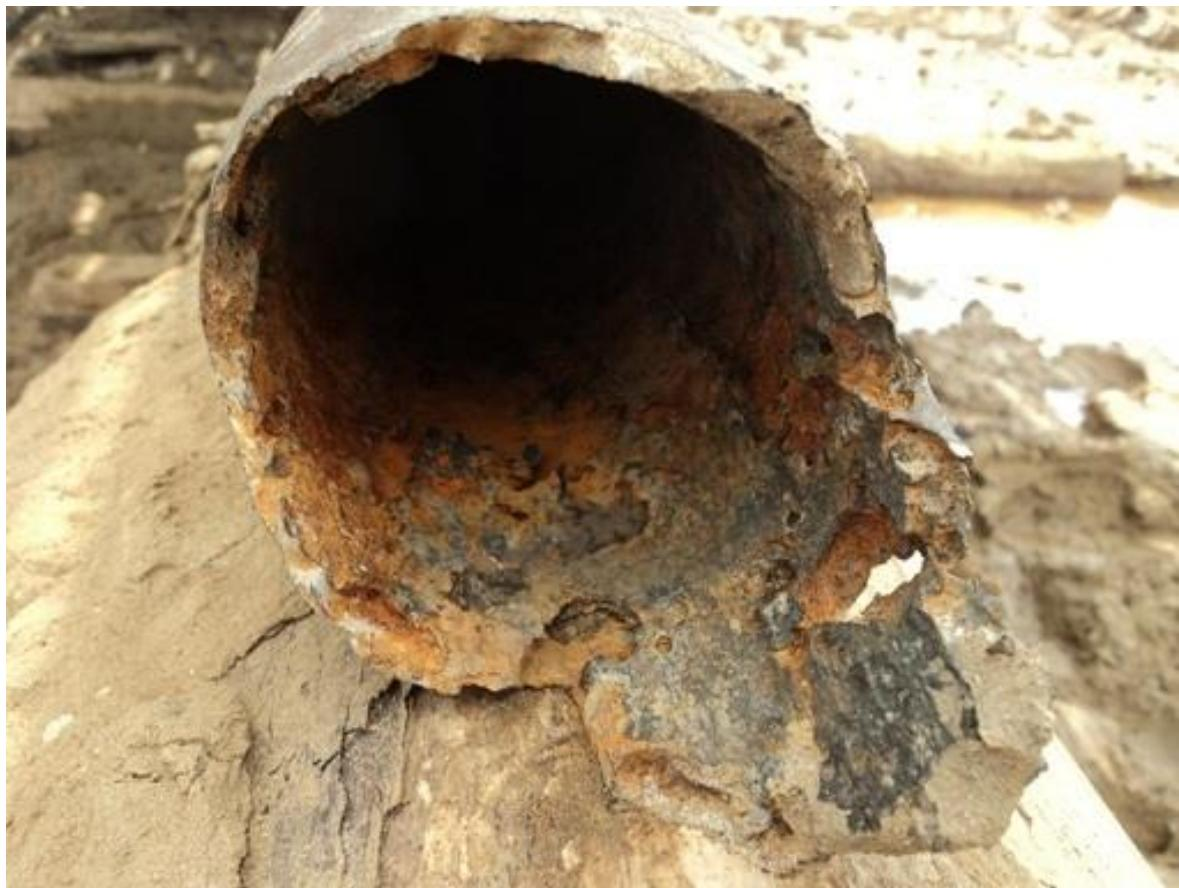
**Slika 3-7.**  $\text{H}_2\text{S}$  korozija (<http://himipex.com>)
