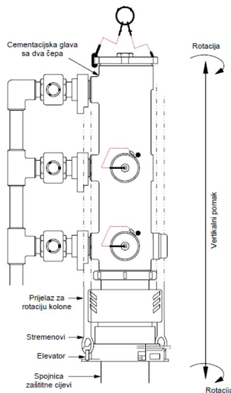
Slika 4-20. Shematski prikaz cementacijske glave (Gaurina-Međimurec, 2020)
