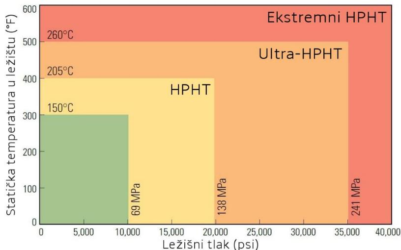
**Slika 3-1.** Shematski prikaz Schlumberger-ove klasifikacije HPHT bušotina (<https://www.slb.com>)
