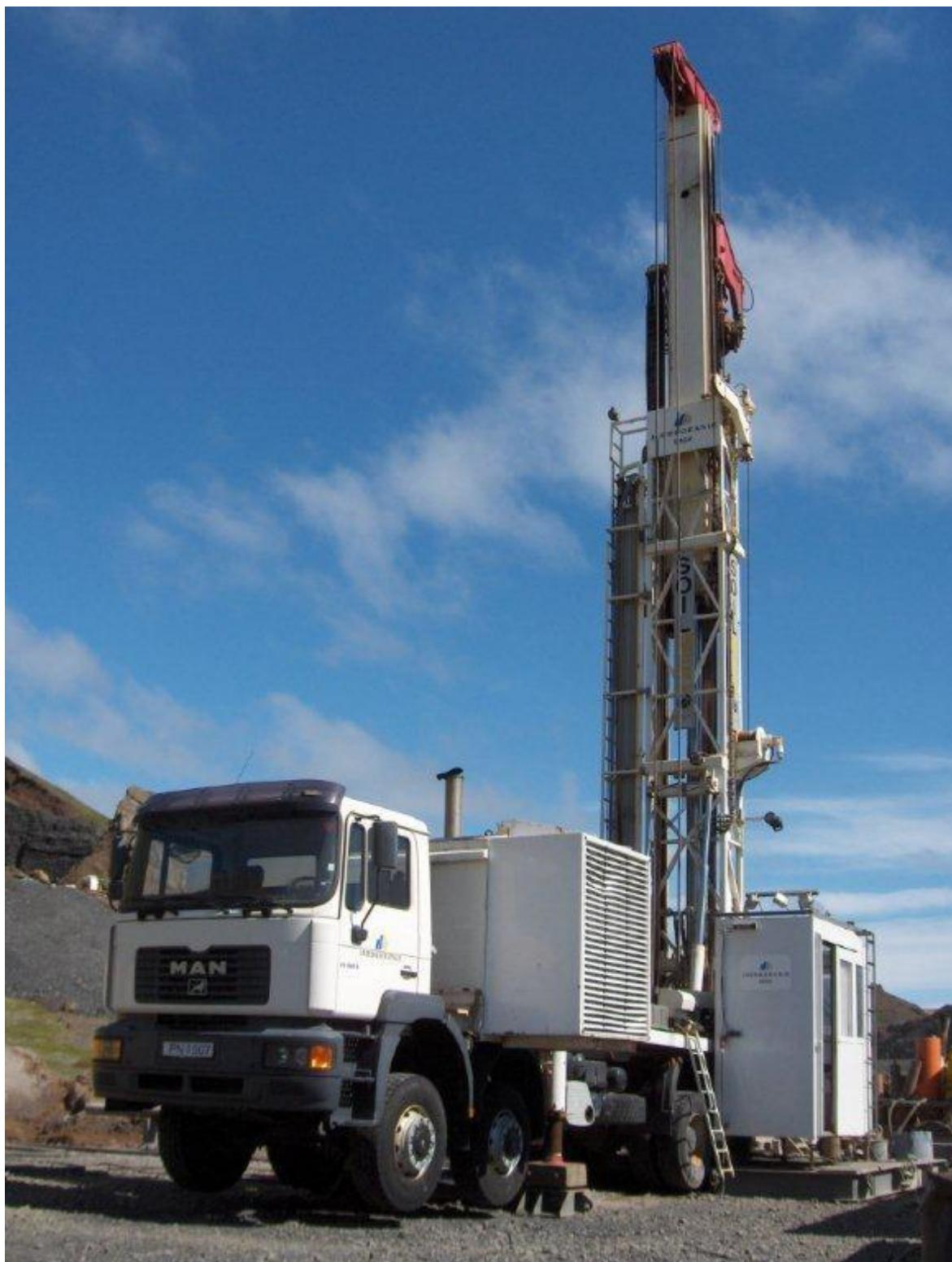
**Slika 4-1.** Mobilno bušaće postrojenje Saga Soilmec G-55
