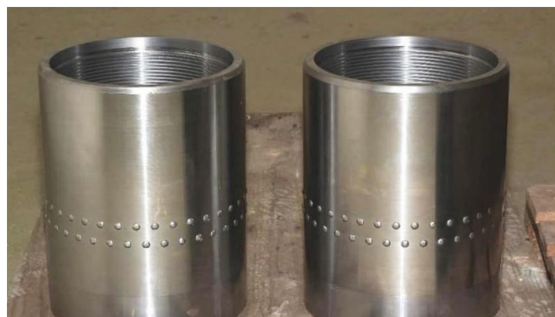
**Slika 4-18.** Prototipovi fleksibilnih spojница (Thorbjornsson et al., 2017)
