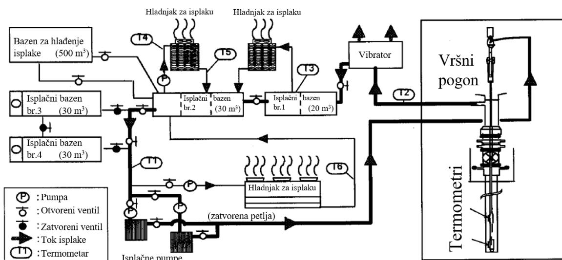
**Slika 4-9.** Shematski prikaz isplačnog sustava korištenog za izradu bušotina s temperaturama preko  $500^{\circ}\text{C}$  (Saito i Sakuma, 2000)
