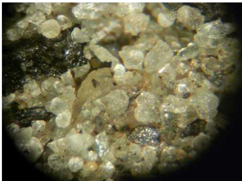
**Slika 5-2.** Mikroskopski prikaz kvarcnog pijeska iz bušotine Boš-1 (Bilić, 2016)
