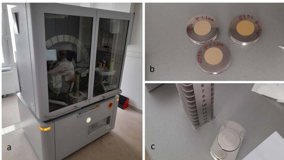
Slika 4.5. a) RTG uređaj, b) nosači uzoraka, c) izmjenjivač uzoraka („sample changer“)
