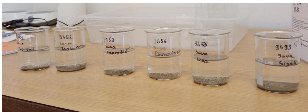
Slika 3–9. Natapanje uzorka u destiliranoj vodi 24 sata prije mjerena s Mastersizerom 3000.
