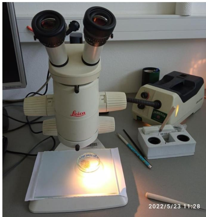
Slika 3–12. Binokularna stereoskopska lupa.
