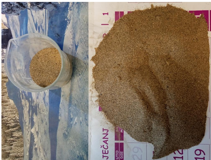
Slika 4–19. Uzorak 9454. Lijevo u laboratorijskoj čaši se nalazi količina uzorka koja se prosijavala kroz set sita, desno se nalazi hrpa koja je odvojena četvrtanjem.
