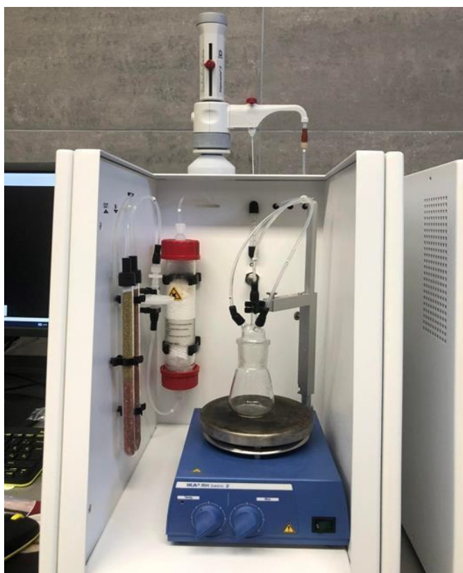
Slika 4.5. Uređaj za mjerenje TIC modula.
