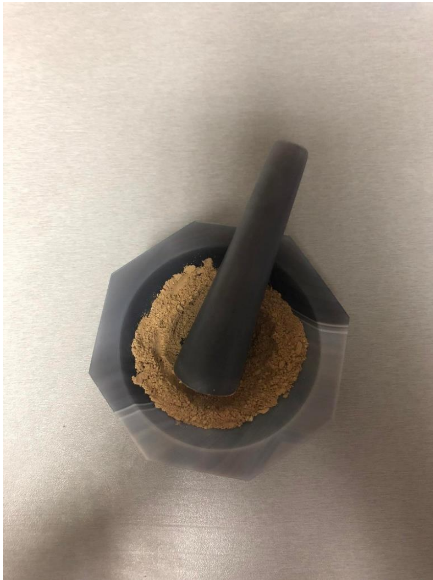
Slika 4.2. Uprašivanje uzorka u ahatnom tarioniku.
