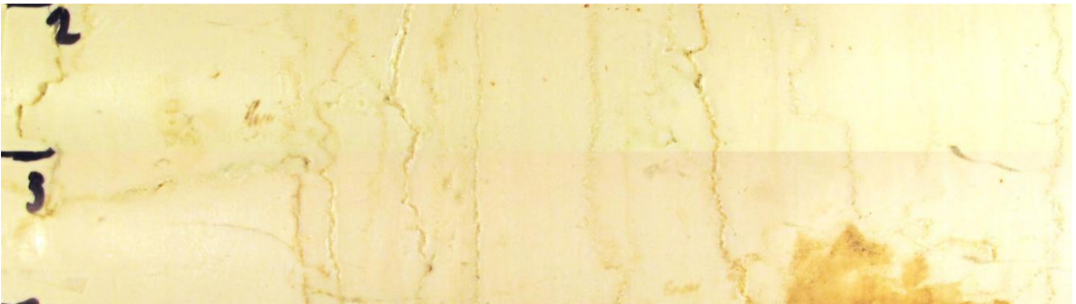
Slika 5.4 Uvećanje plašta uzorka KIR-V-A-UCS-4, čiji je intenzitet raspucanosti okarakteriziran kao izražen.
