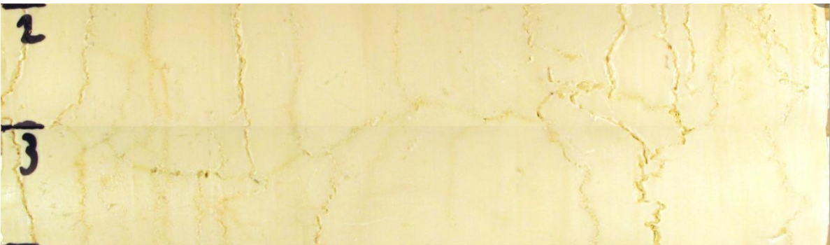
Slika 5.5 Uvećanje plašta uzorka KIR-V-A-UCS-5, čiji je intenzitet raspucanosti okarakteriziran kao vrlo izražen.
