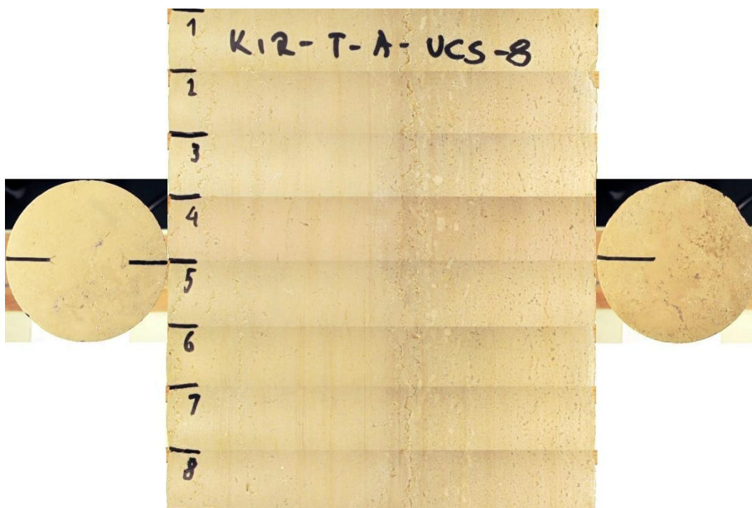
Slika 4.3 Razvijen plašt uzorka tamnog varijeteta Kirmenjaka laboratorijske oznake KIR-T-A-UCS-8. Na uzorku se vidi laminacija, kao prijelaz iz tamnog prema svijetlom varijetetu kirmenjaka. Na plaštu su vidljivi stilolitski šavovi koji su paralelni s bazama. Vidljive su i onkoidi te kalcitna zrna.
