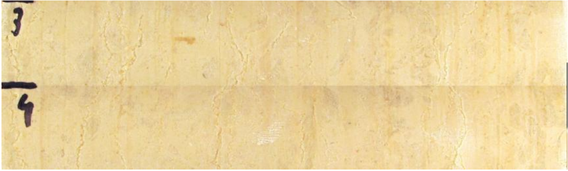
Slika 5.6 Uvećanje plašta uzorka KAN-IV-A-UCS-10, čiji je intenzitet raspucanosti okarakteriziran kao umjeren.
