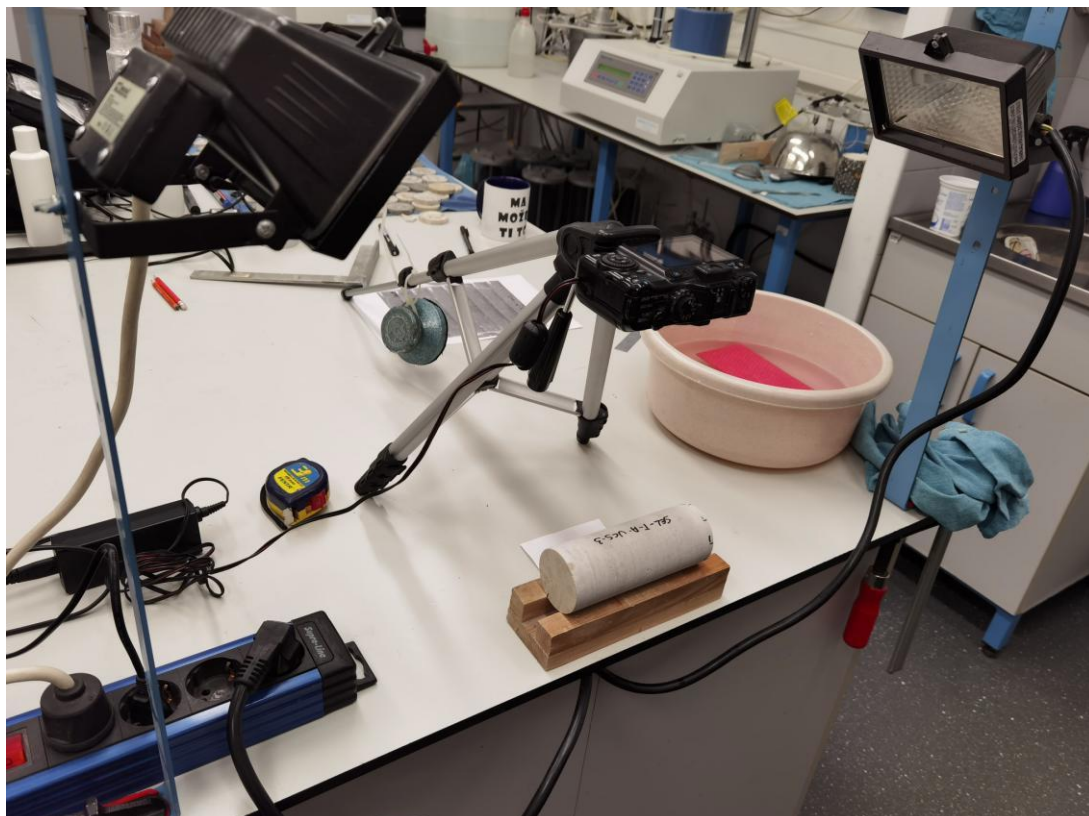
Slika 3.4 Aparatura za slikanje uzoraka.
