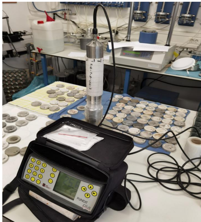
Slika 3.5 Mjerenje vremena prolaska ultrazvučnih valova.
