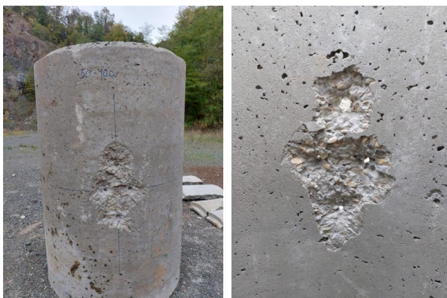
Slika 8-8. Učinak naboja koristeći raspored 50 mm x 100 mm
