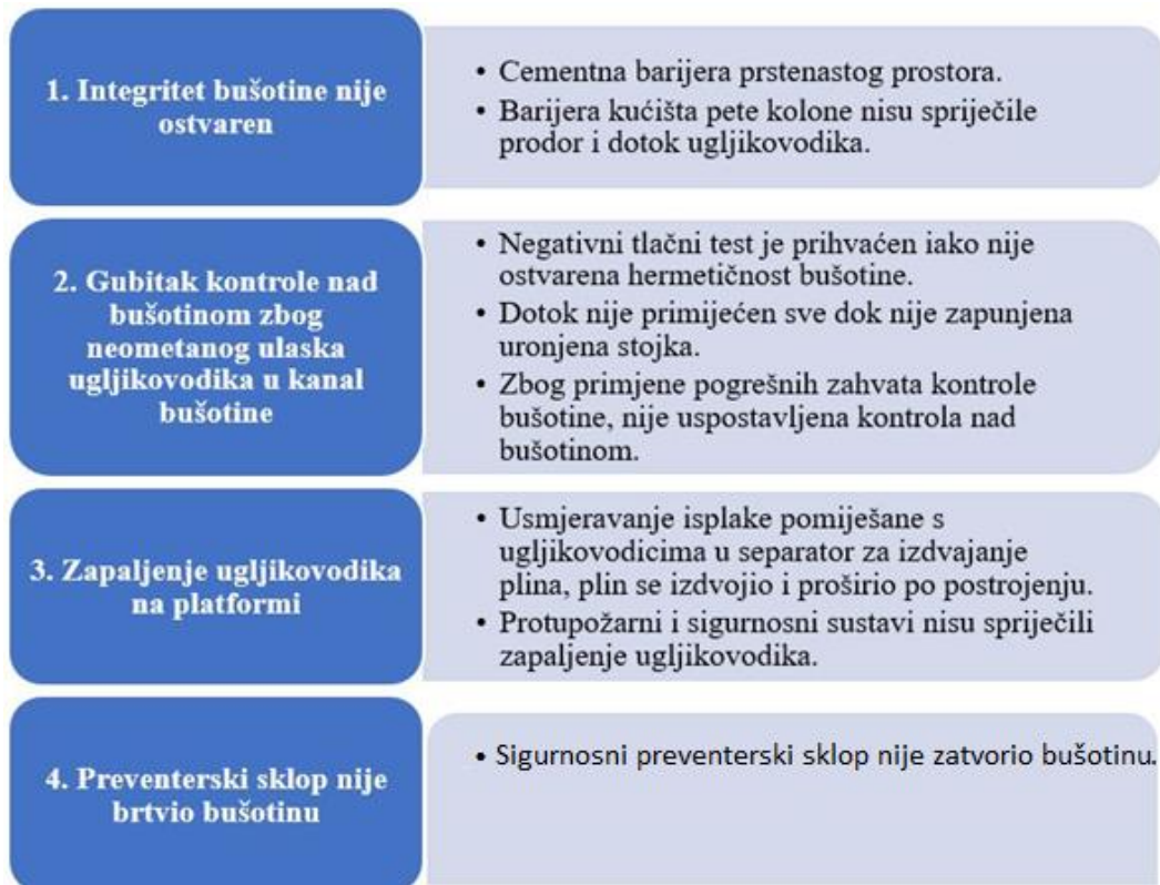
Slika 4-5. Prikaz faktora rizika i probijenih barijera na bušotini Macondo 252 (British Petroleum, 2010).
