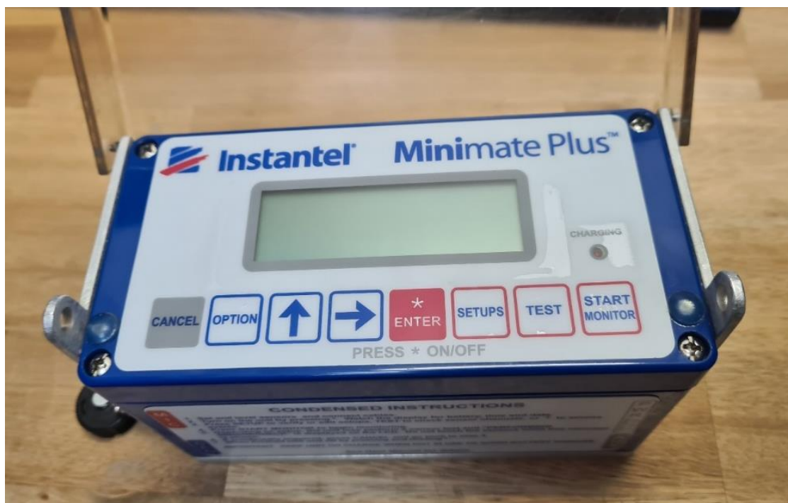
Slika 2-3. Instrument za mjerenje brzina oscilacija tla InstanTel Minimate Plus
