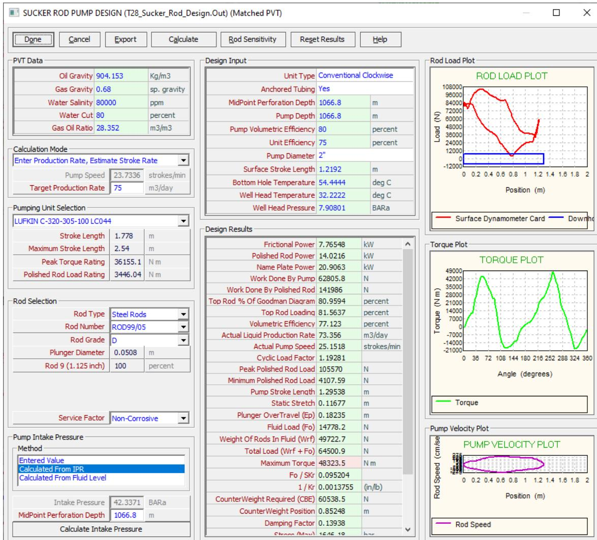
Slika 4-13. Ulagani podaci za dizajniranje dubinske crpke s klipnim šipkama u bušotini X
