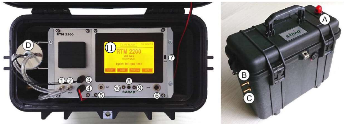
Slika 6-1 Mjerni uređaj RTM 2200 Soil Gas, (Sarad, 2007)
