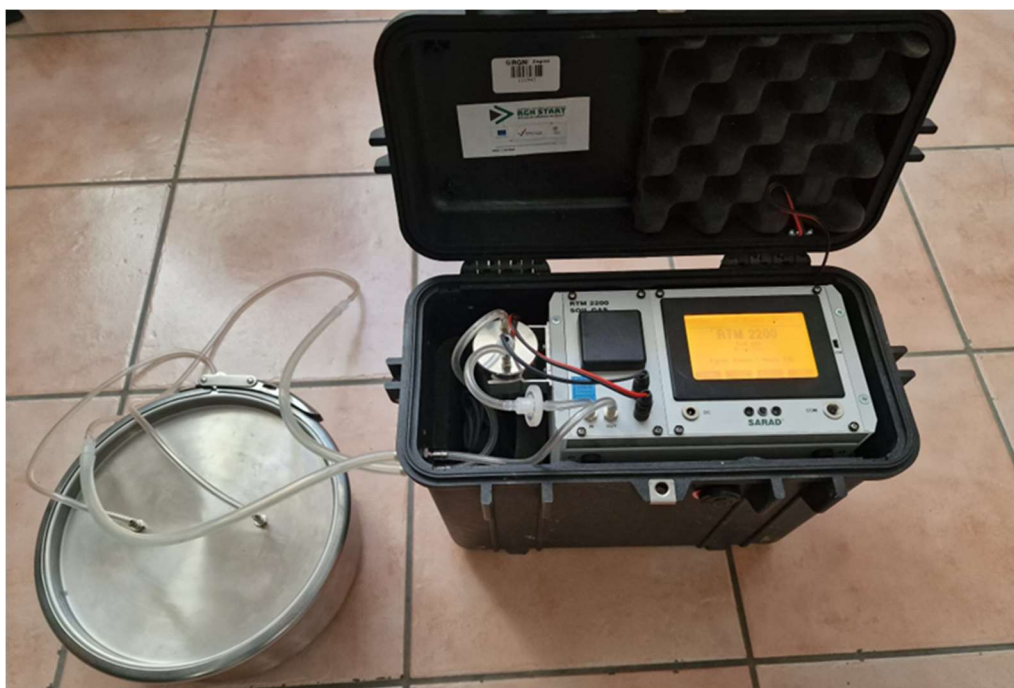
Slika 7-1 Inertna posuda s uzorkom spojena na mjerni uređaj RTM2200
