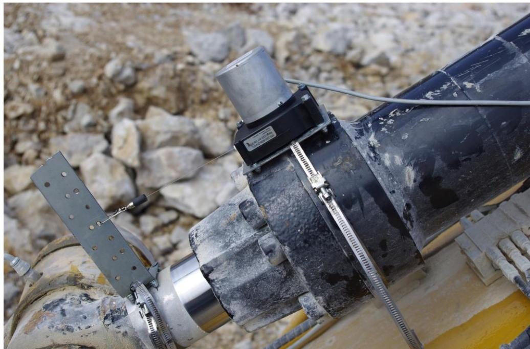
*Slika 4.2. Ugradnja linearног mjernog pretvornika položaja.*
