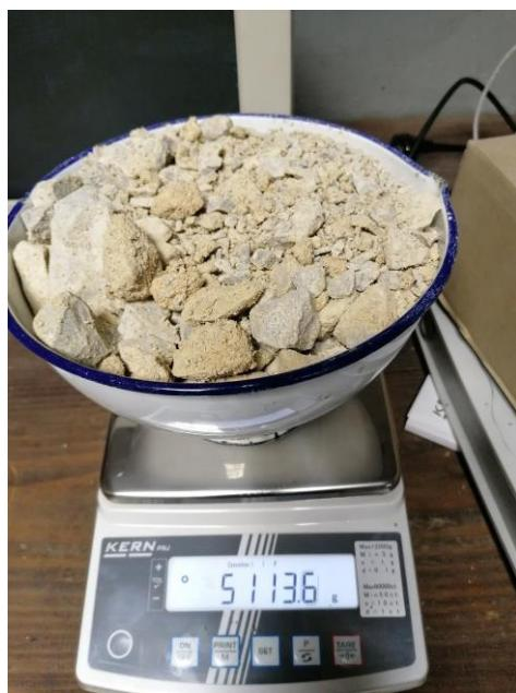
*Slika 4.16. Određivanje mase uzorka na elektronskoj vagi*
