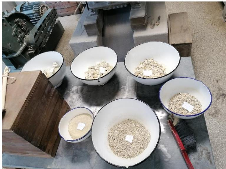
Slika 4.17. Određivanje granulometrijskoga sastava nekoherentnih materijala
