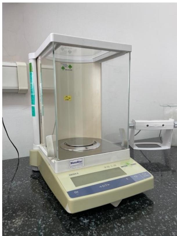
**Slika 5-2.** Analitička vaga Mettler Toled
