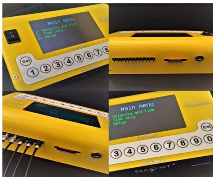
Slika 4-1. Explomet 2 uređaj (KONTINITRO, 2019)
