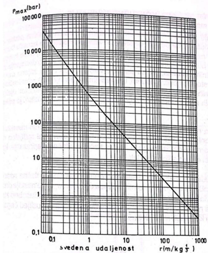
Slika 3-1. Maksimalni tlak u tlačnom udarnom valu u vodi na razmaku  $R = r \cdot Q^{1/3}$  za slobodno obješeni eksplozivni naboј u vodi (Krsnik, 1989.)
