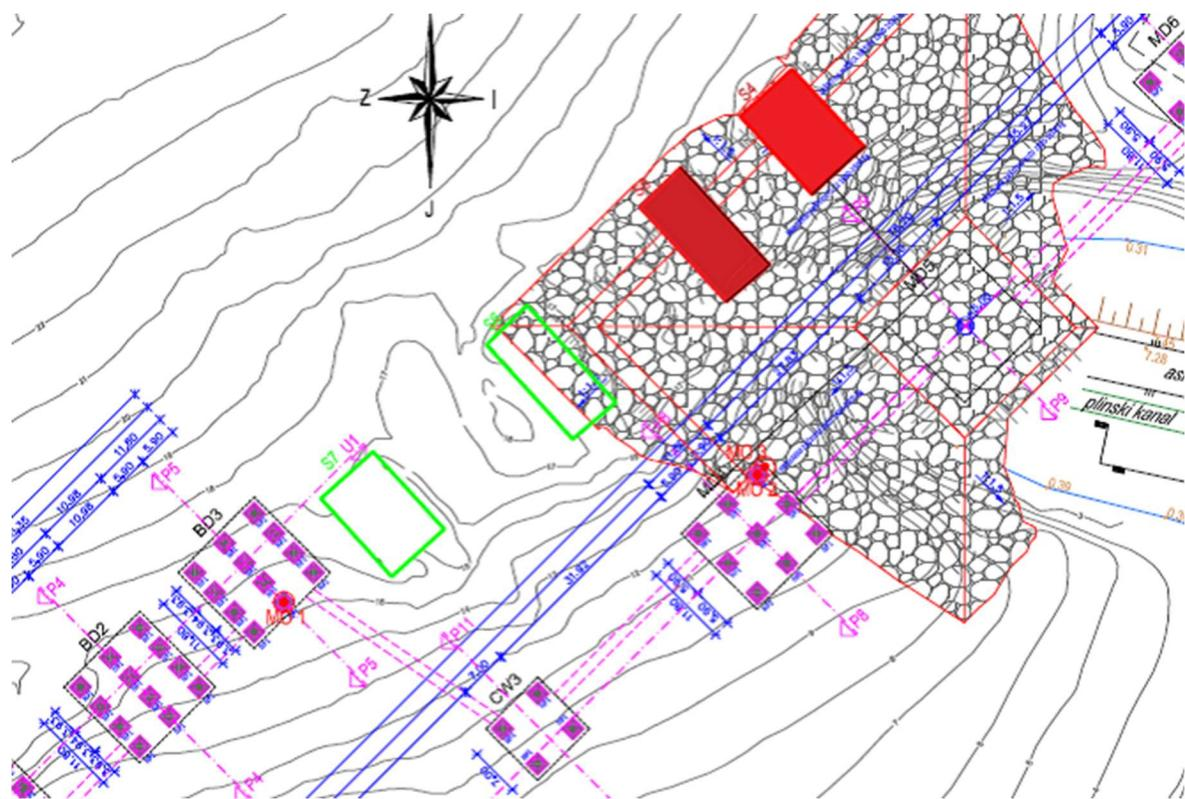
Slika 7-2. Položaj mesta mjerena i raspored mjernih točaka prilikom miniranja utvrđice S5 i ostataka S4 (Buljan, 2020.)
