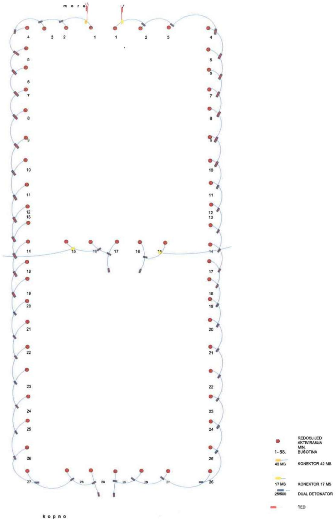
Slika 6-11. Shema spajanja i redoslijed usporavanja minskih bušotina na minskom polju 1 utvrdice S6 (Buljan, 2020.)
