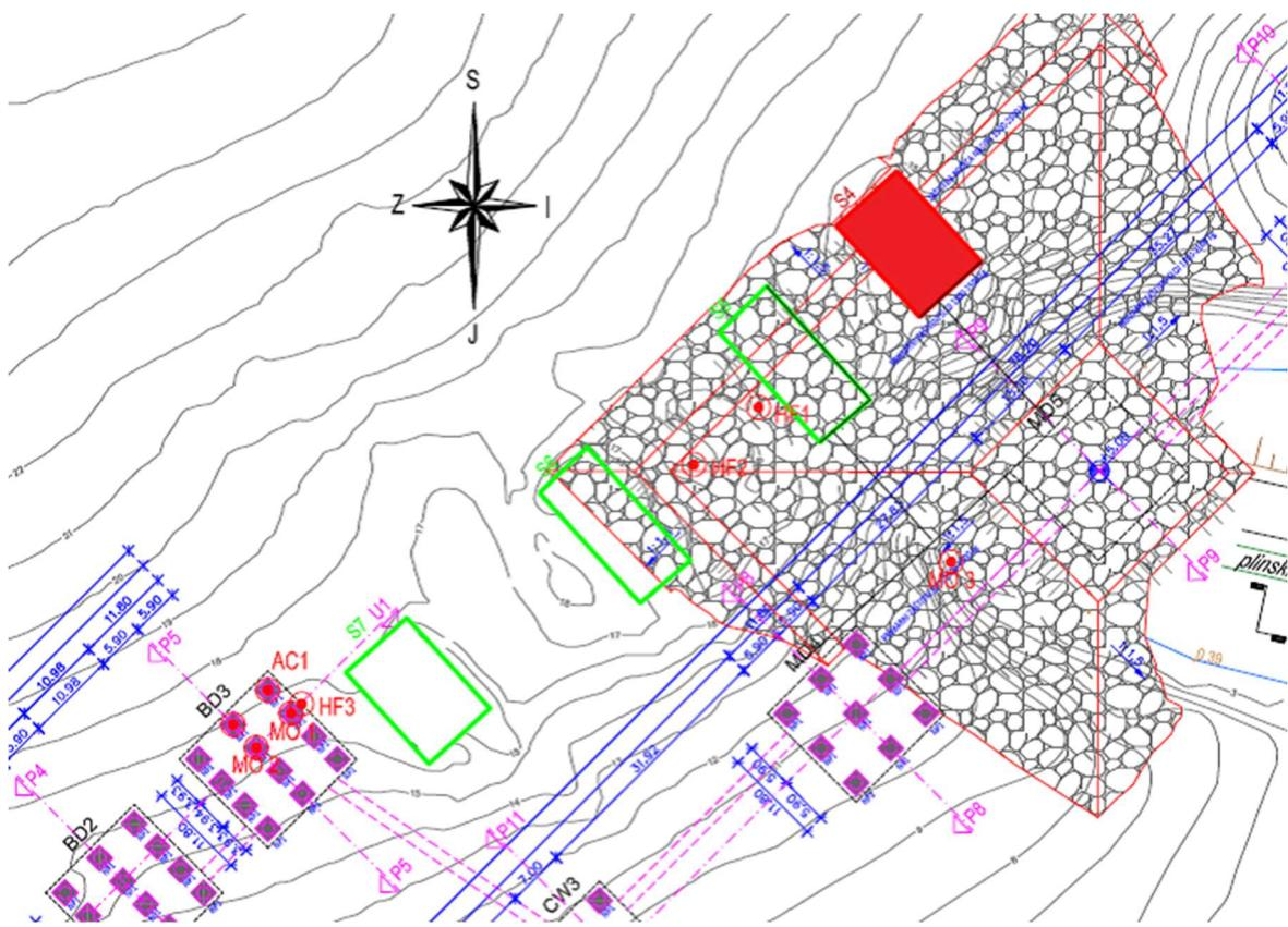
**Slika 7-1.** Položaj mjesta mjerjenja i raspored mjernih točaka prilikom miniranja utvrdice S4 (Buljan, 2020.)
