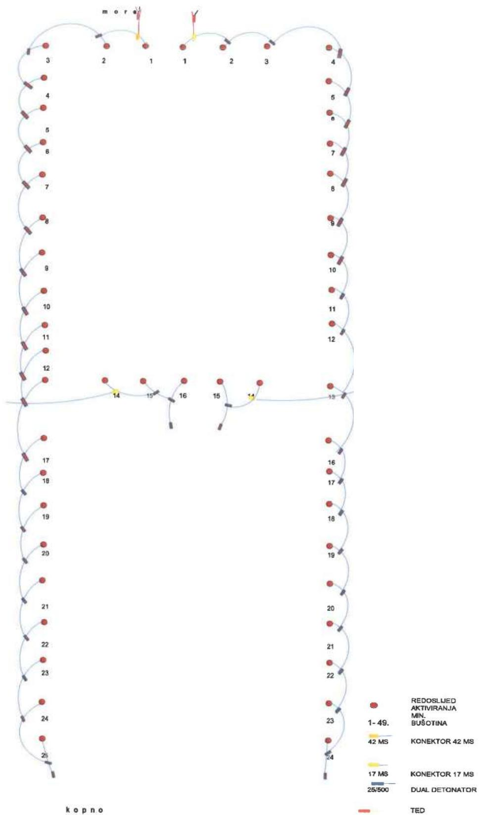
**Slika 6-6.** Shema spajanja i redoslijed usporavanja minskih bušotina polja 1 na utvrđici S5 (Buljan, 2020.)
