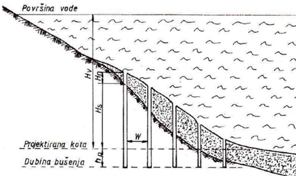
Slika 2-5. Poprečni presjek podvodnog iskopa (Ester, 1989.)
