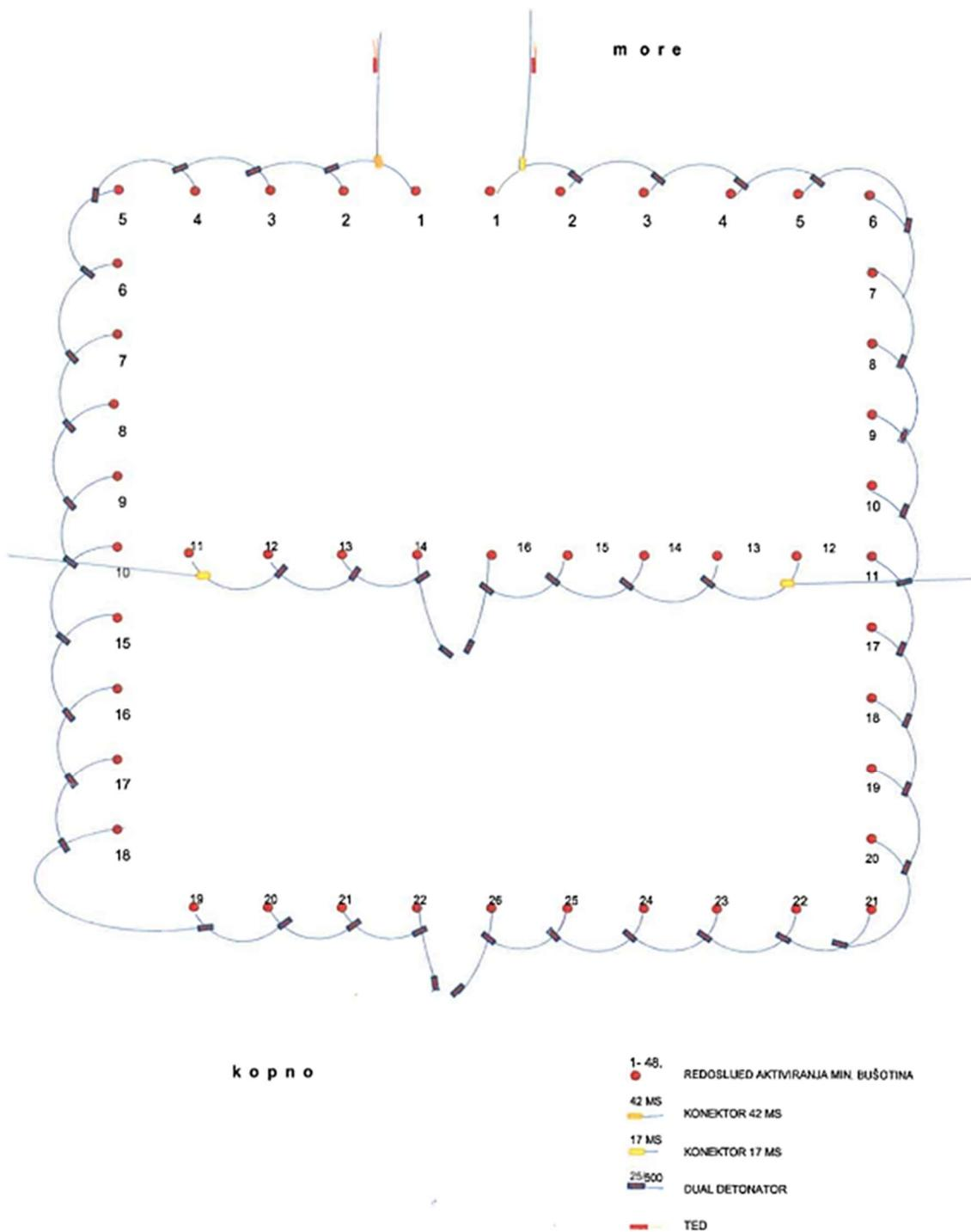
Slika 6-13. Shema spajanja i usporavanja minskih bušotina polja 1 na utvrđici S7 (Buljan, 2020.)
