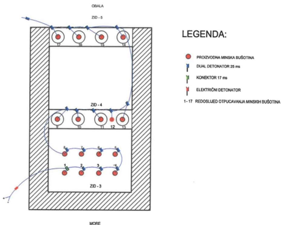
**Slika 6-8.** Shema povezivanja i redoslijed otpucavanja minskih bušotina – utvrđica S4 (Buljan, 2020.)
