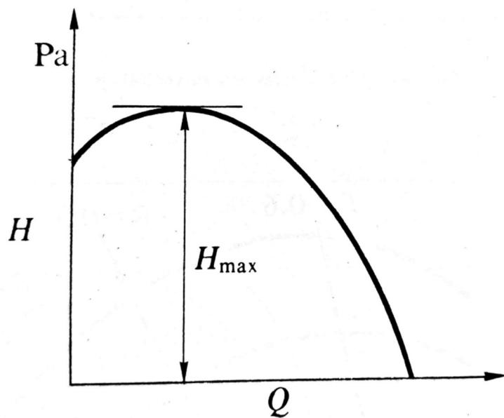
Slika 3-18. Grafički prikaz tipične karakteristike ventilatora (Teply, 1990.)
