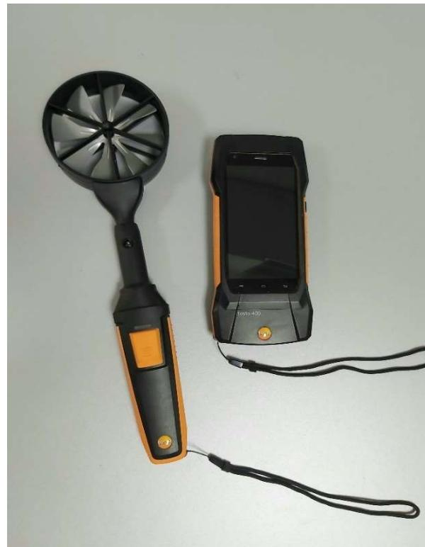
**Slika 2-6.** Krilna sonda i multifunkcijski mjerni uređaj TESTO 400
