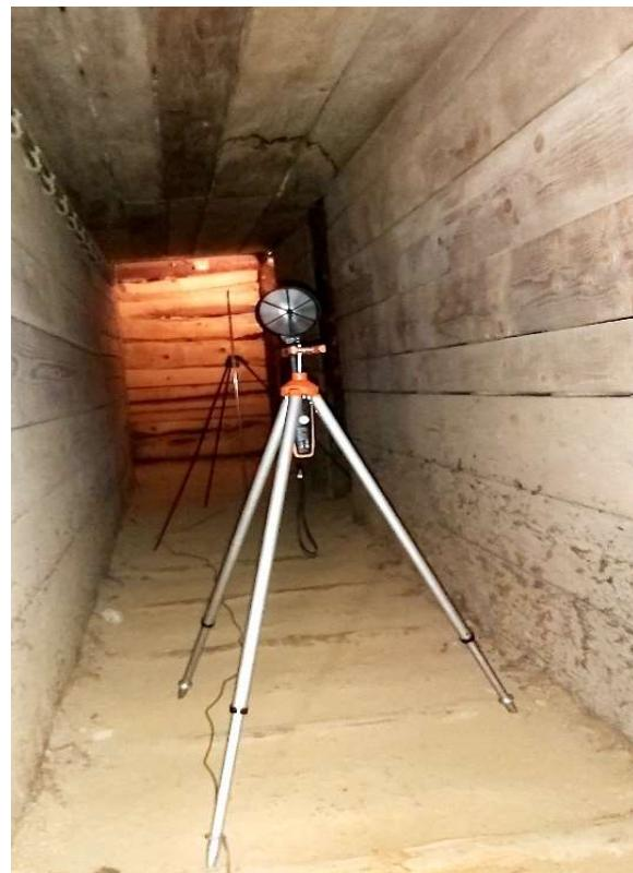
**Slika 2-7.** Krilna sonda i Pittotova cijev na stalcima
