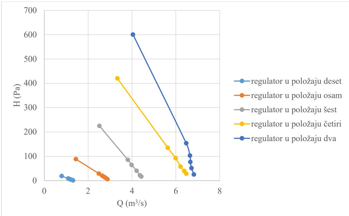
Slika 3-17. Grafički prikaz svih dobivenih karakteristika ventilatora ovisno o položaju regulatora
