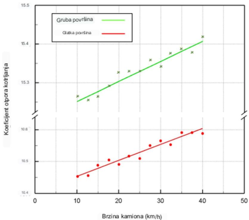
Slika 4-2. Odnos brzine kamiona i koeficijenta otpora kotrljanja kod hrapavih i glatkih površina (A.Sooftastaei i sur.,2015.)
