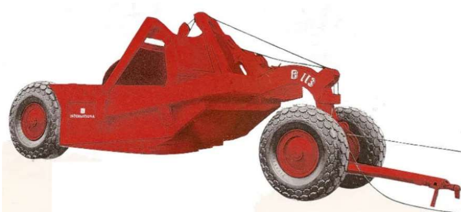
Slika 2-2. Prvi praktični vučeni skreper (Contractor,2016)
