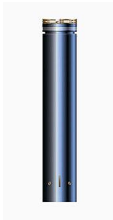
Slika 4-2. GPIT sonda za orijentaciju slike (Schlumberger, 2004)
