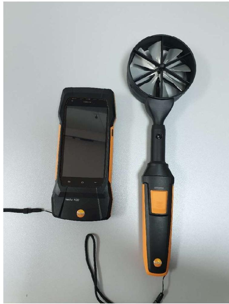
**Slika 4-5.** Multifunkcijski uređaj za mjerjenje Testo 400 sa krilnom sondom
