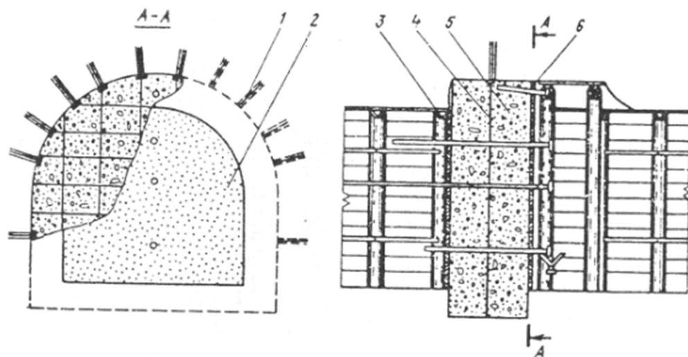
1 – anker; 2 – prekrivka; 3 i 6 – obloga; 4 – armatura; 5 – beton.
