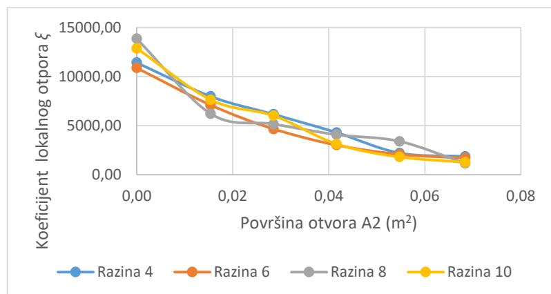
**Slika 6-1.** Grafički prikaz odnosa koeficijenta lokalnog otpora  $\xi$  i površine otvora A2
