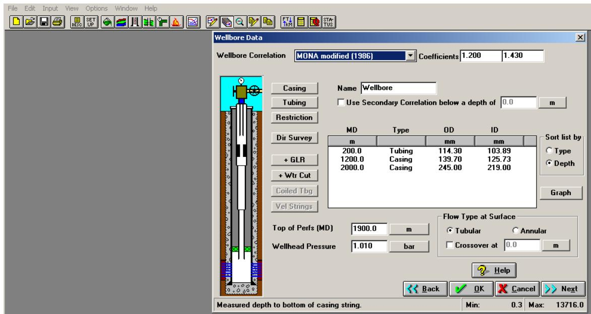
**Slika 4-2.** Prikaz osnovnog sučelja programa WellPerform i unošenja podataka vezanih za konstrukciju bušotine Ježevi-X s opremom nakon zamišljene revitalizacije
