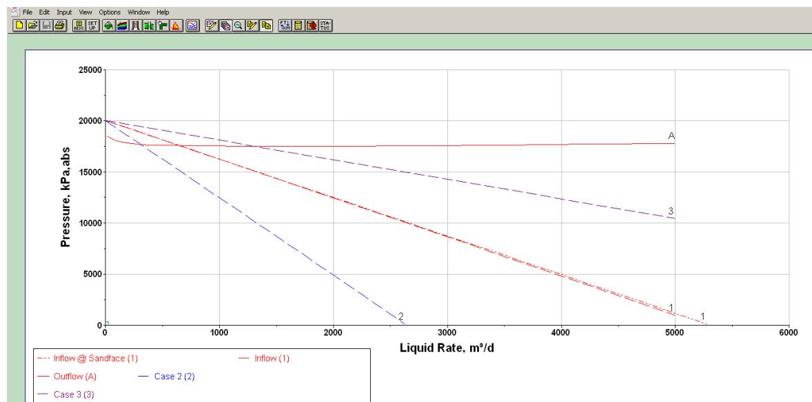
**Slika 4-4.** Rezultati proračuna proizvodnje programa WellPerform za tri scenarija kumulativnih debljina propusnih gama serija Iva pješčenjaka od 100 m (Inflow 1 – Case -1), 50 m (Case-2) i 200 m (Case-3)
