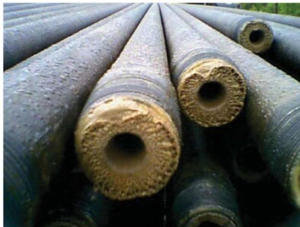
Slika 2-3. Primjer smanjenja protočne površine cijevi uzrokovane izdvajanjem barijevog sulfata (Bellarby, 2009)
