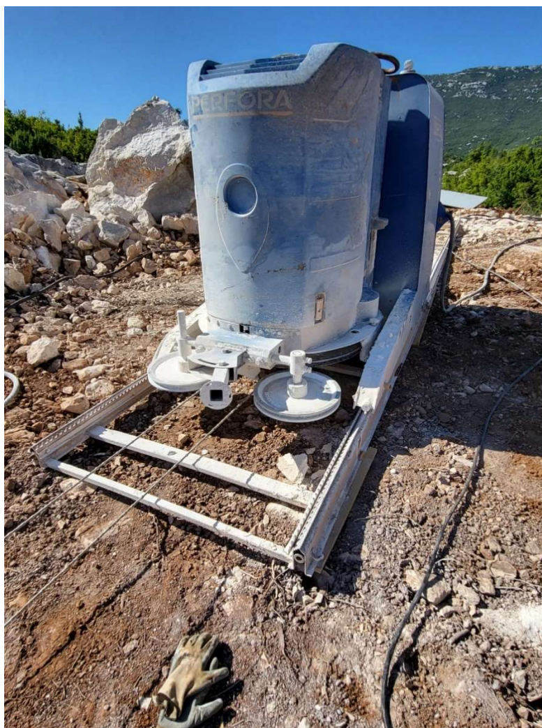
Slika 2-1. Dijamantna žična pila marke Perfora.
