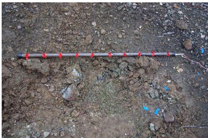
**Slika 4-2.** Postav mjerenja brzine detonacije u čeličnim cijevima.
