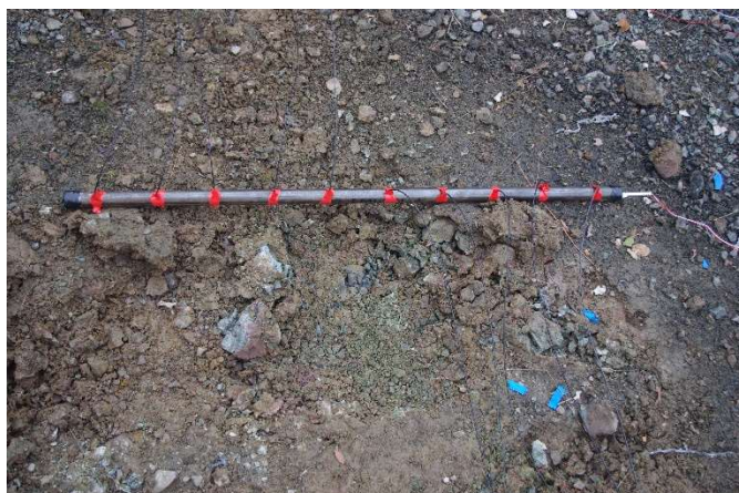
Slika 4-2. Postav mjerenja brzine detonacije u čeličnim cijevima.
