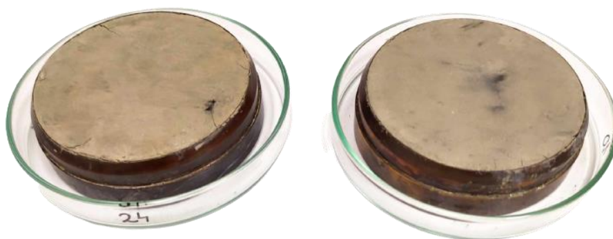
Slika 4-6. Uzorci nakon ispitivanja u edometru (fotografirala: M. Gavrić)
