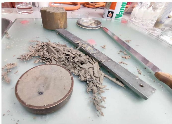
Slika 4-5. Priprema uzorka za ispitivanje u edometru (fotografirala: M. Gavrić)
