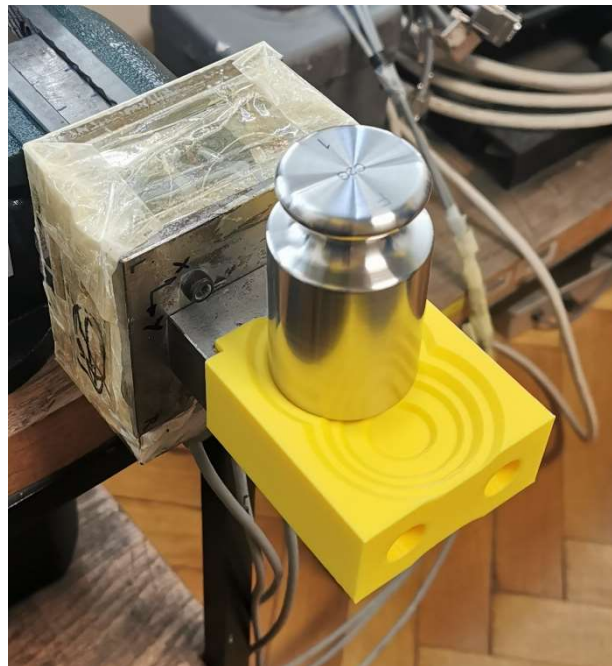
Slika 5-18. Opterećenje EC dodatka utegom neke mase
