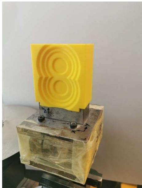
Slika 5-17. Dodatak EC pričvršćen na senzor
