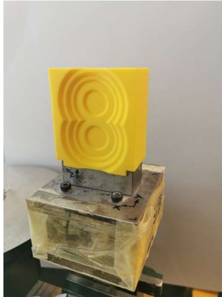
Slika 5-17. Dodatak EC pričvršćen na senzor
