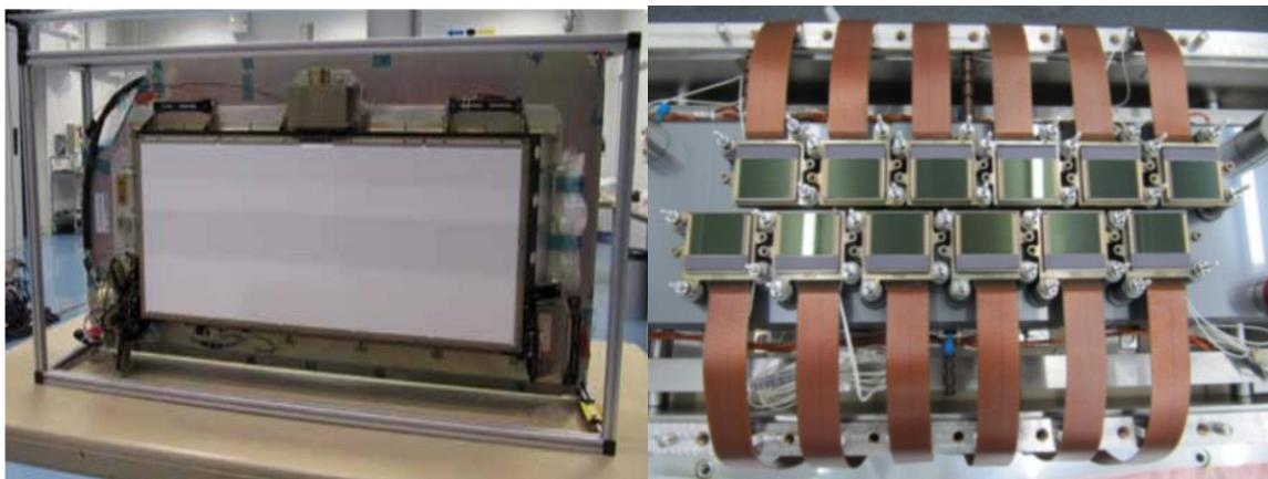
Slika 3-3. a) CSM mehanizam MSI instrumenta s prikazom difuzora za kalibraciju prema suncu. b) Fokalna ravnina za NIR (ESA, 2023)
