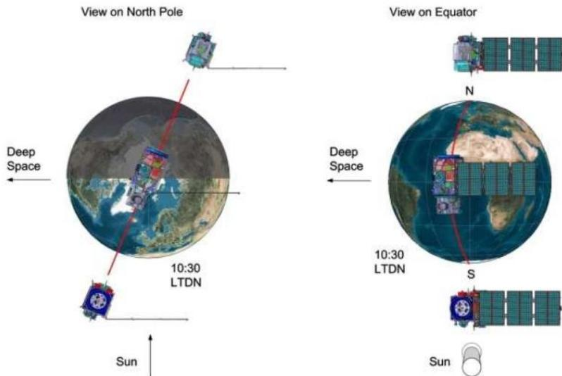
Slika 3-2. Orbitalna konfiguracija blizanaca-satelita SENTINEL-2 (ESA, 2023)
