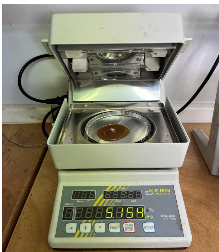
Slika 7-9. Određivanje MLSS-a pomoću KERN analitičke vaga
