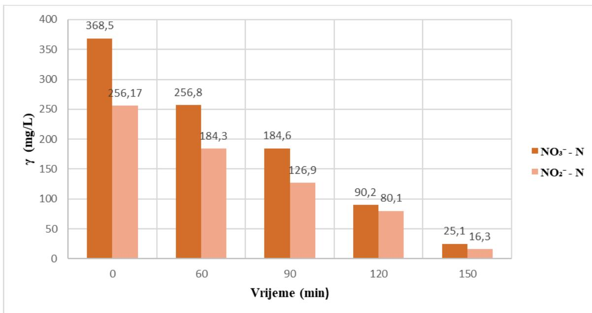
Slika 7-14. Grafički prikaz promjene masenih koncentracija  $\text{NO}_3^-$ -N i  $\text{NO}_2^-$ -N s vremenom trajanja denitrifikacije
