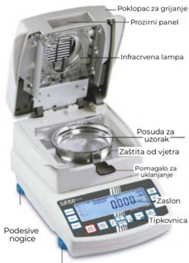
Slika 7-1. Dijelovi KERN uređaja
