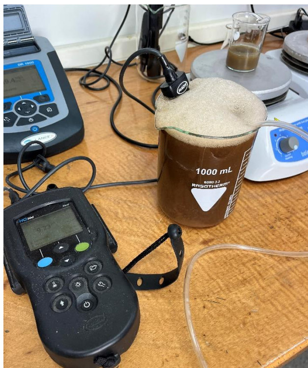
Slika 7-11. Laboratorijski simuliran proces nitrifikacije
