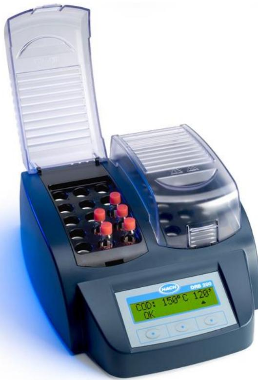
**Slika 3-4.** Hachov reaktor za određivanje KPK
