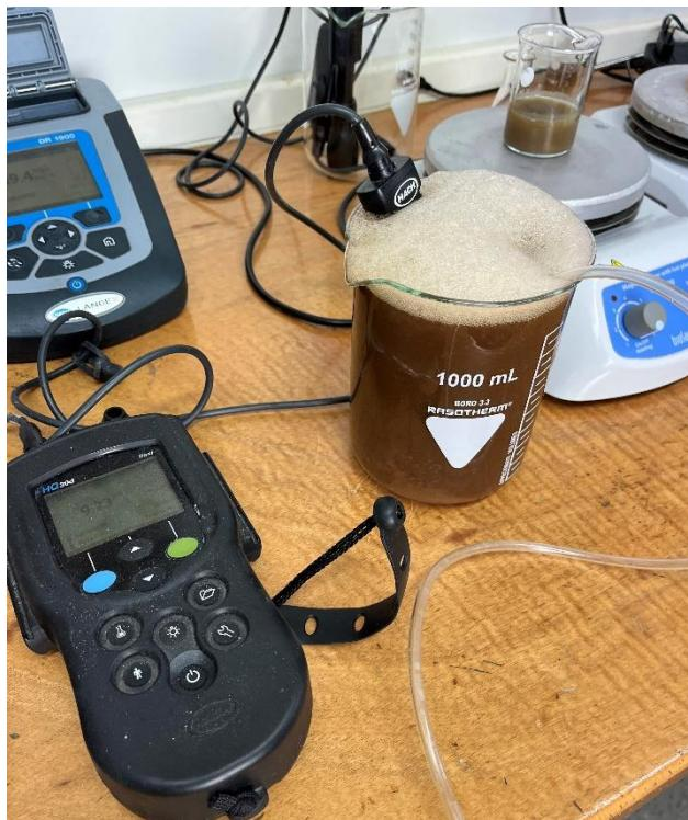
**Slika 7-11.** Laboratorijski simuliran proces nitrifikacije
