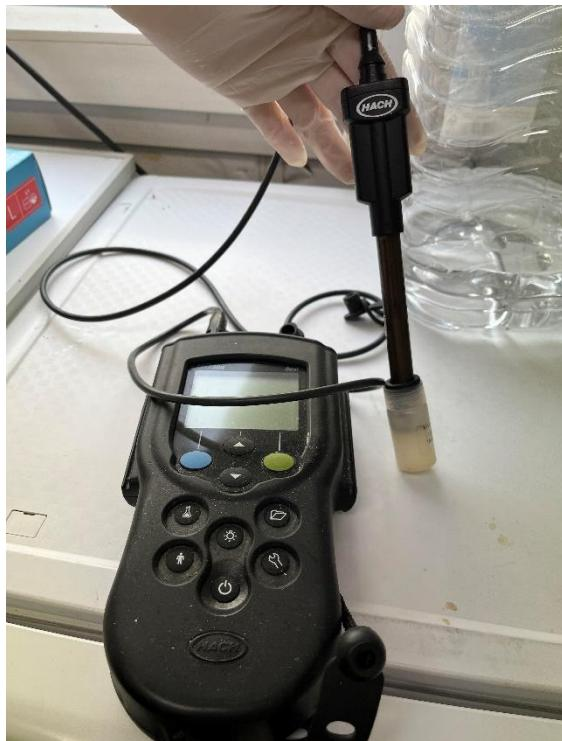
**Slika 7-3.** Hach HQ40D uređaj sa sondama za mjerjenje pH vrijednosti i koncentracije otopljenog kisika
