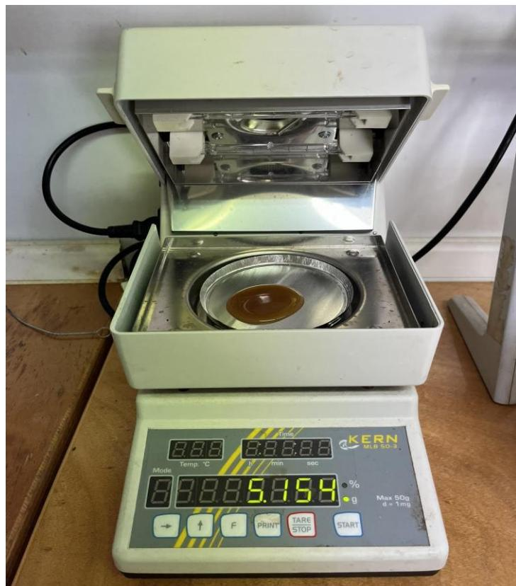
**Slika 7-9.** Određivanje MLSS-a pomoću KERN analitičke vaga
