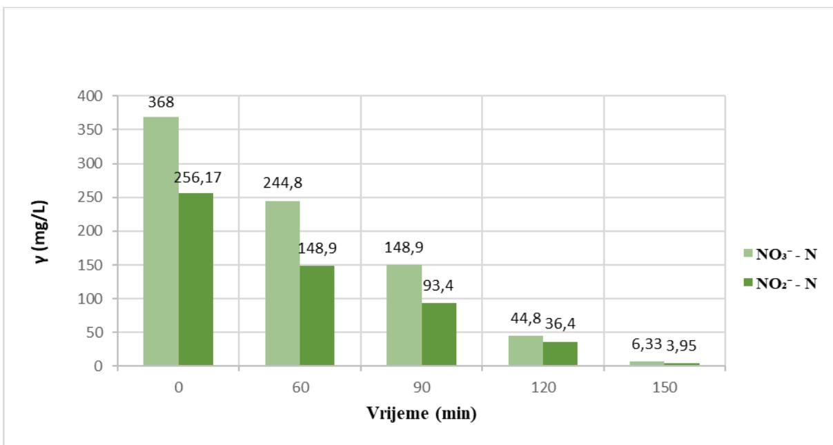
Slika 7-16. Grafički prikaz promjene masenih koncentracija  $\text{NO}_3^- - \text{N}$  i  $\text{NO}_2^- - \text{N}$  u ovisnosti o vremenu
