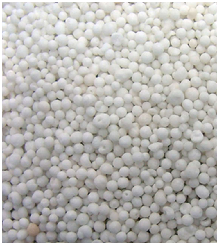
Slika 4-8. Granule korištenog ANFO eksploziva
