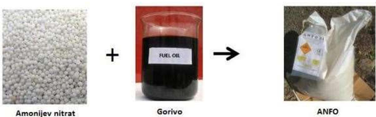
Slika 3-1. Shematski prikaz proizvodnje ANFO eksploziva (Bohanek 2016)
