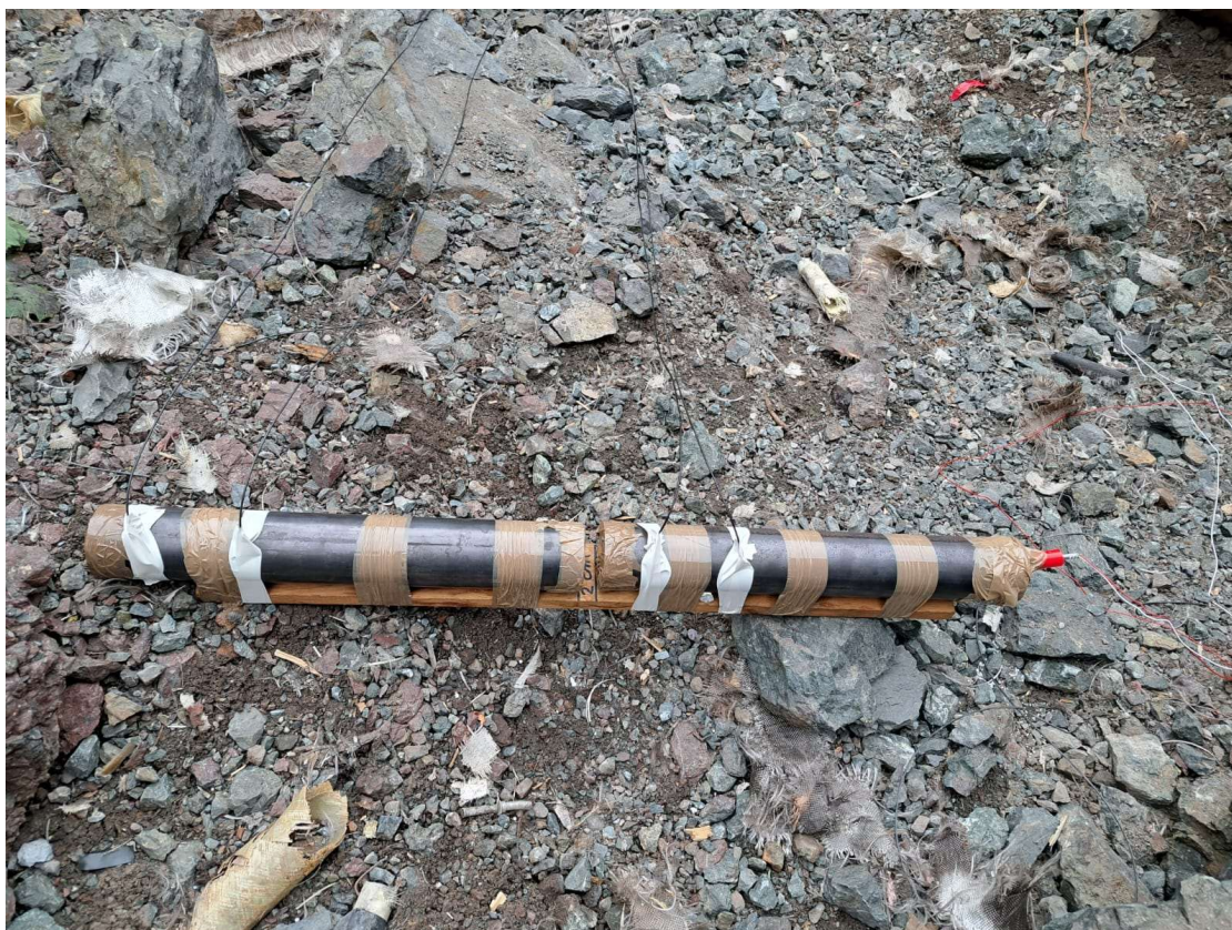
Slika 4-12. Ispitni uzorak postavljen za ispitivanje s razmakom patrona 2 cm
