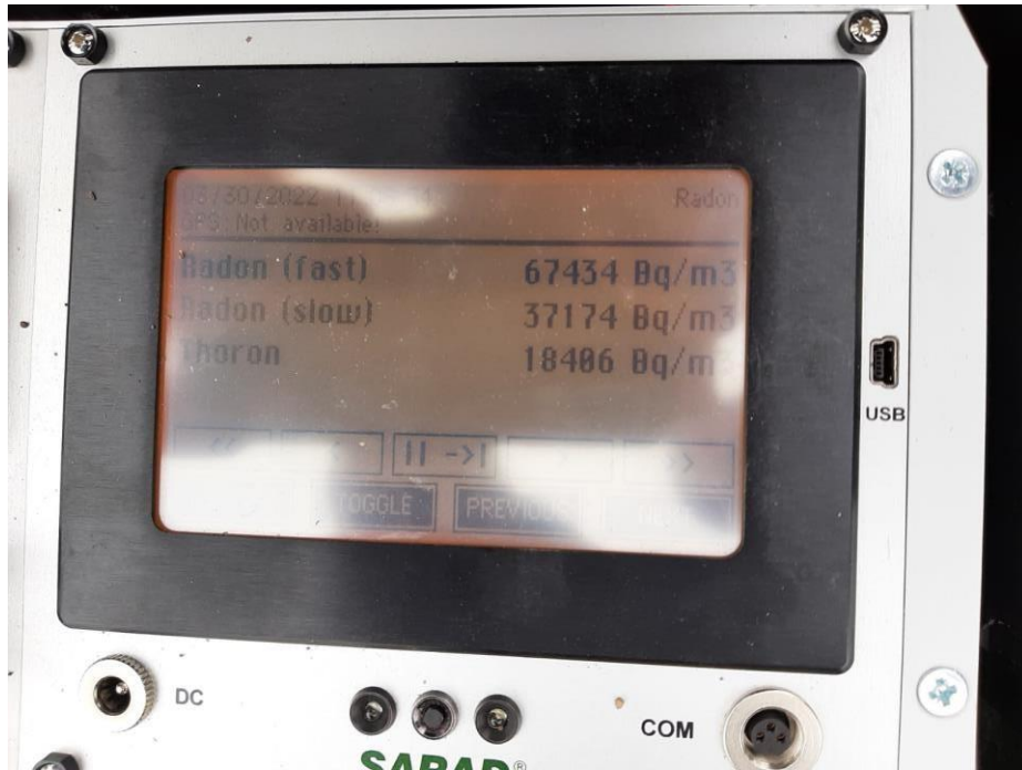
Slika 4.3-3. Rezultati mjerenja koncentracije radona u zraku tla.
