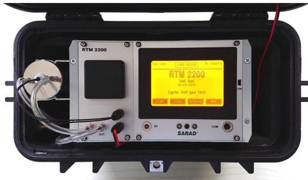
Slika 4.2-2. Uređaj za mjerenje koncentracije radona. (SARAD, 2020)
