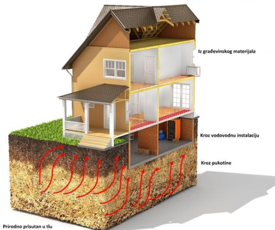
Slika 4.1-1. Ulazak radona u zatvorene objekte. (Zbrinjavanje radioaktivnog otpada, 2023)
