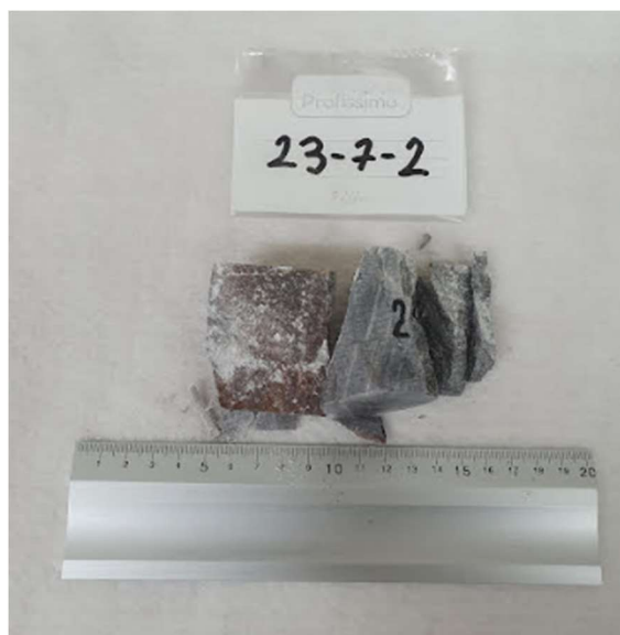
Slika 4-2. Prikaz uzorka 23-7-2 nakon sloma
