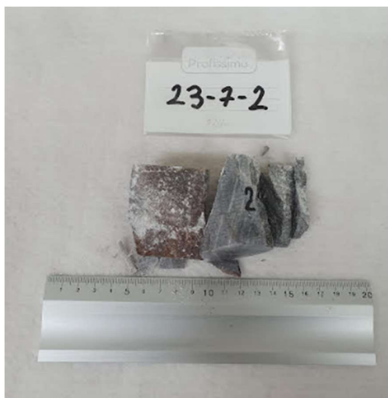
Slika 4-2. Prikaz uzorka 23-7-2 nakon sloma
