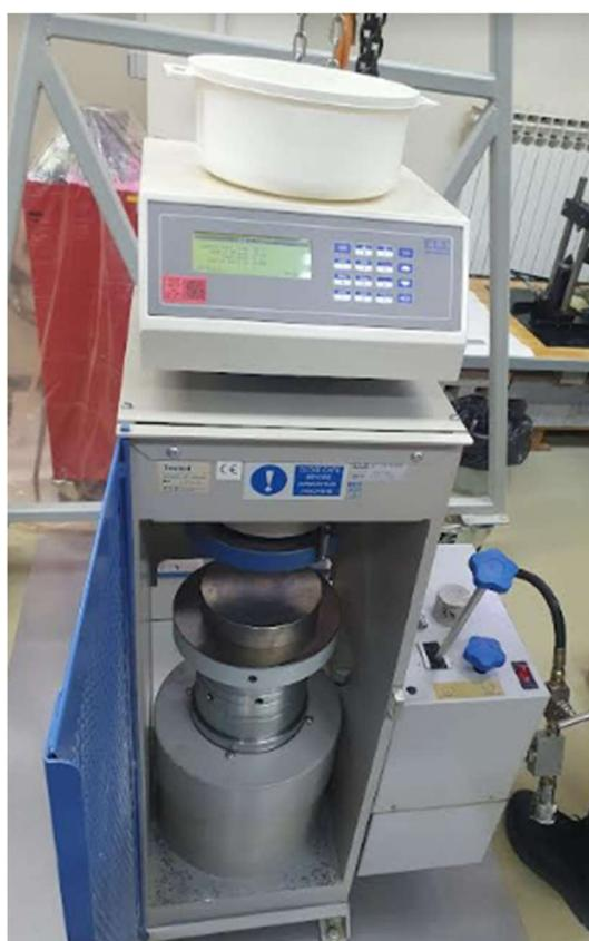
Slika 3-2. Prikaz uređaja za ispitivanje jednoosne tlačne čvrstoće
