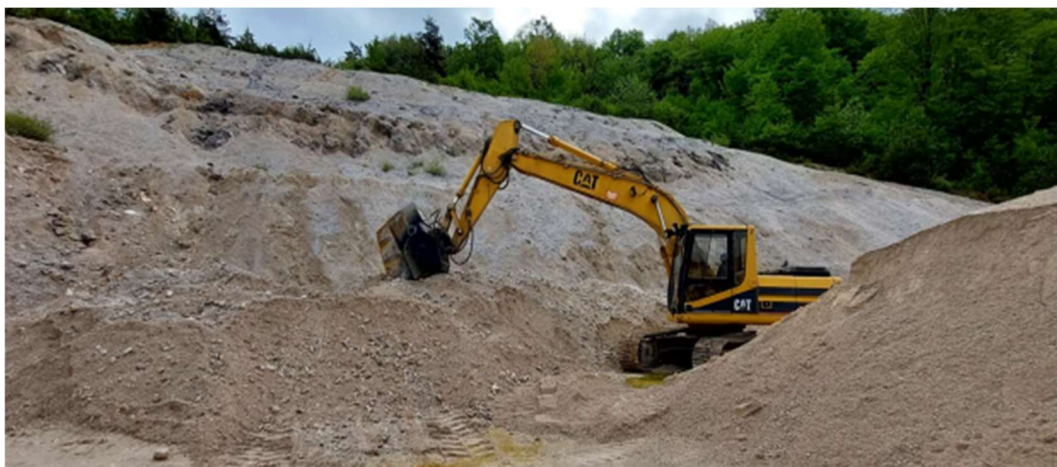
Slika 4-4. Bager s montiranom čeljusnom drobilicom(Galić i dr., 2023)
